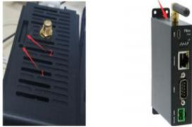
3.1.2 使用φ2左右的螺丝刀或其它尖锐物品用力压1点, 可将2处的卡托推出, 本卡托为标准尺寸的SIM卡托, 如下图所示:
