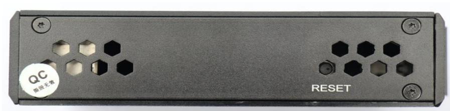
设备带有系统复位按钮 RESET，当用户忘记设备的 IP 地址及配置端口号而不能连接网关时，可触发复位按钮。系统参数将恢复出厂设置并重启设备，可采用回形针点击复位按钮，所有指示灯闪亮一次表示复位成功。网关复位成功，网关的技术参数如下：
