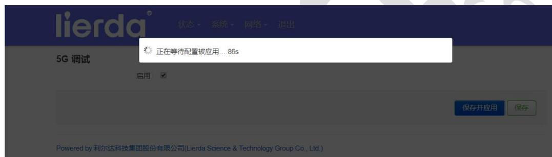
可进入 5G 模块调试模式，使用 AT 指令与模块通信，如输入模块查询指令 AT+CGMM 输出 MH5000-31
