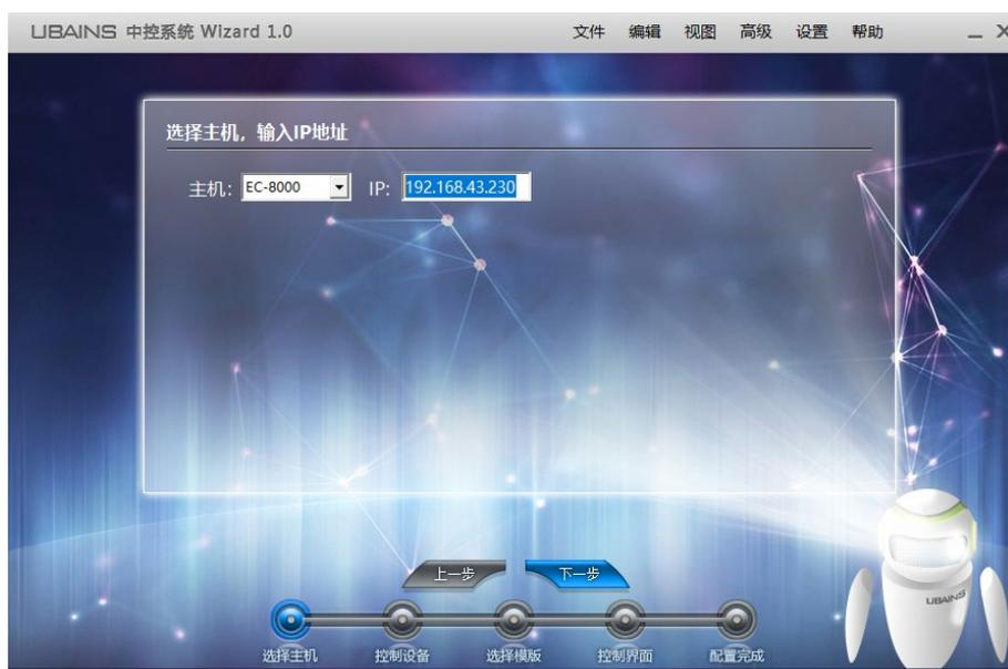
(路径为“设置-IP 设置-主机 IP”，打开修改框)
