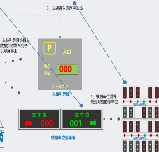
园区部署的云平台可实现对车位占用的联接，对车位占用状态准确感知，实现对空闲车位数和分布的精准统计，实时进行停车指引；
