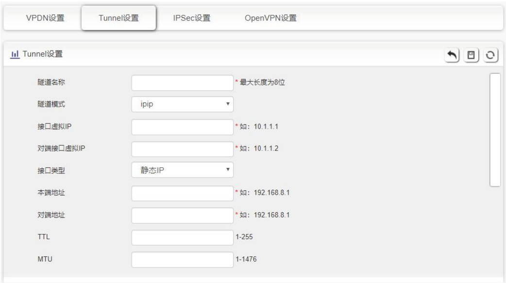
图 5-29 Tunnel 配置页面
