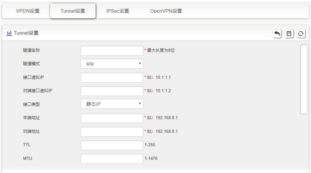
图 5-29 Tunnel 配置页面
