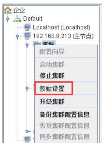
集群核心参数的设置界面如下图，双击要修改的参数的 Value 列，即可修改参数值，某些参数的修改可优化集群性能，建议在专家的指导下修改。
