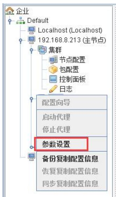
复制核心参数的设置界面如下图, 双击要修改的参数的“值”列, 即可修改参数值, 某些参数的修改可优化复制性能, 建议在专家的指导下修改。
