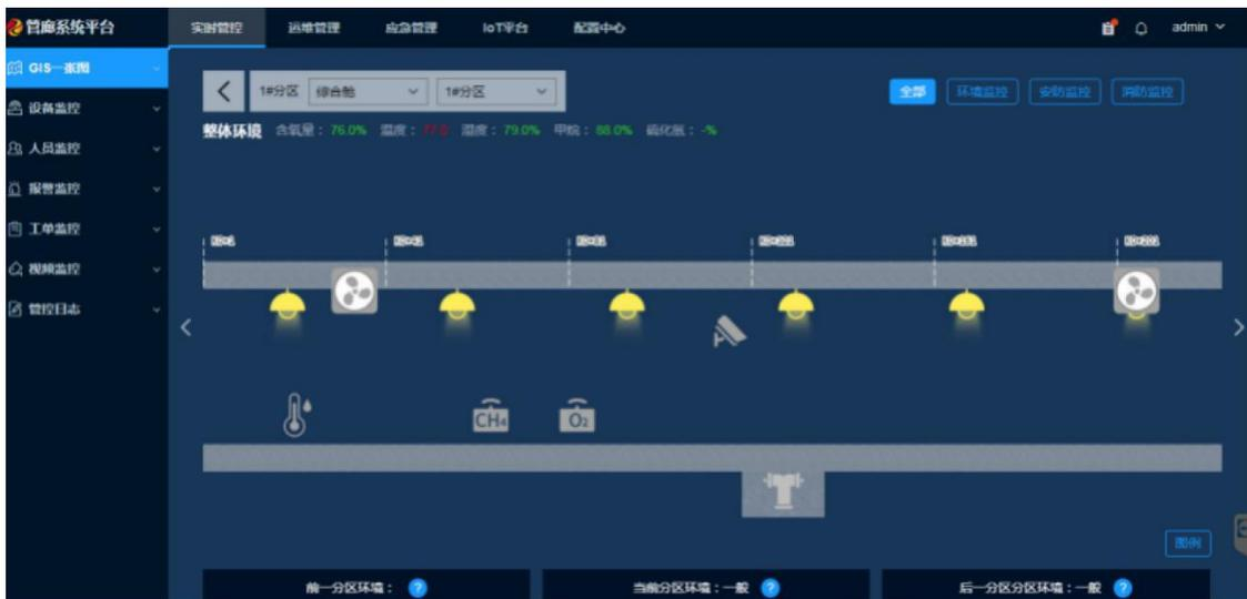
管廊内机电设备包括排水泵、通风机、排烟机、照明设备等，实现的控制功能为：
