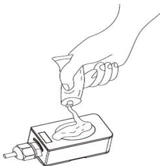
在探头底部椭圆形部位上涂抹耦合剂（704 硅胶），并用钢带进行固定
