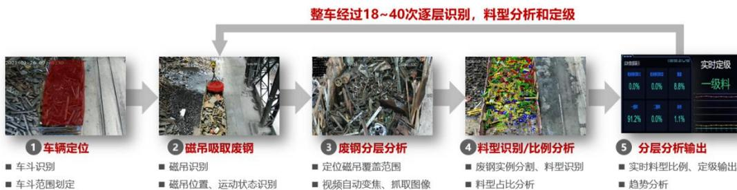
图 16 废钢定级算法关键步骤
