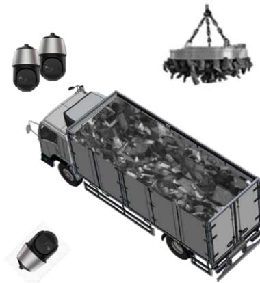
图 15 废钢成像智能控制系统摄像机建议安装方式
