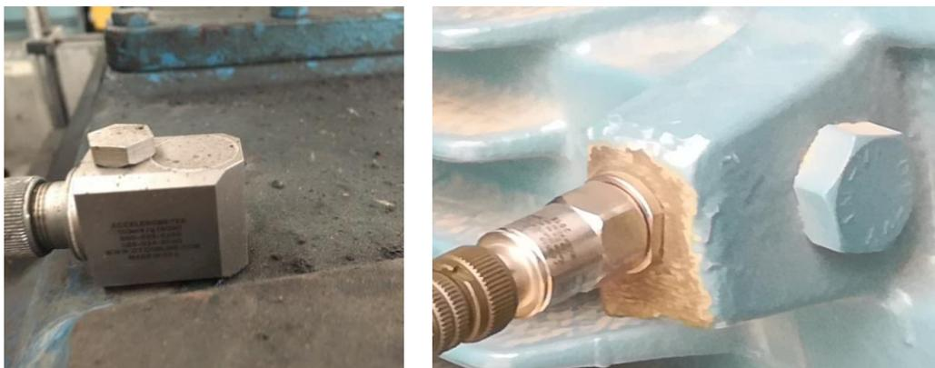
传感器采用转接螺柱安装方式
