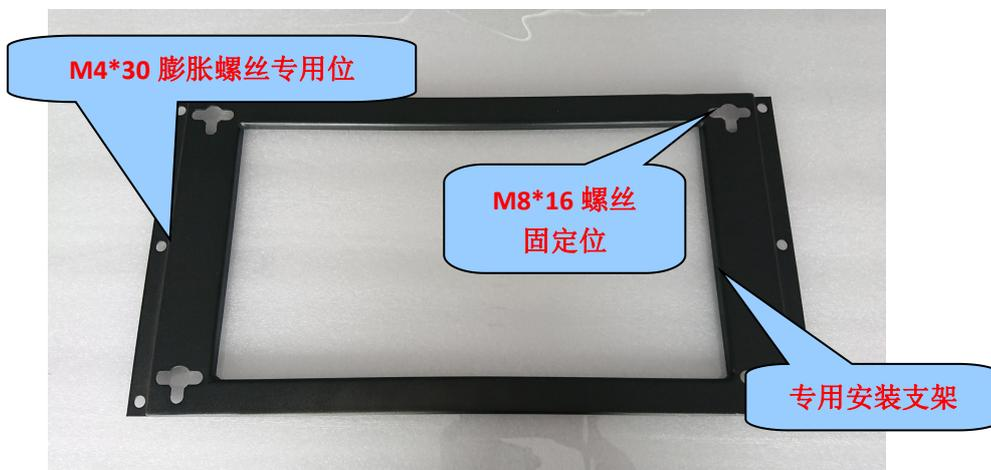
调整好 4 个 M8\*16 挂屏螺丝，间隙大概 2mm，两人平稳抬起广告机，挂在墙面上。
