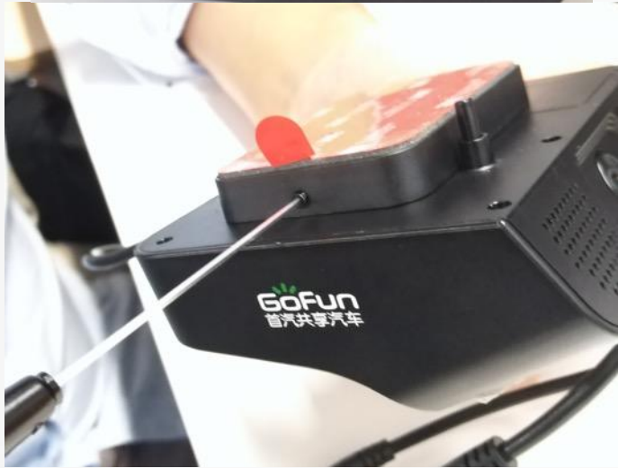
滑入滑动支架（向箭头所示方向滑动） 并锁紧六角螺丝
