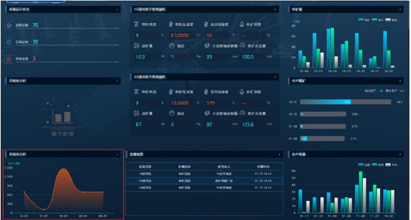
月耗电分析展示最近五个月份的耗电量曲线图，最近五个月份没有数据的时候会显示暂无数据。
