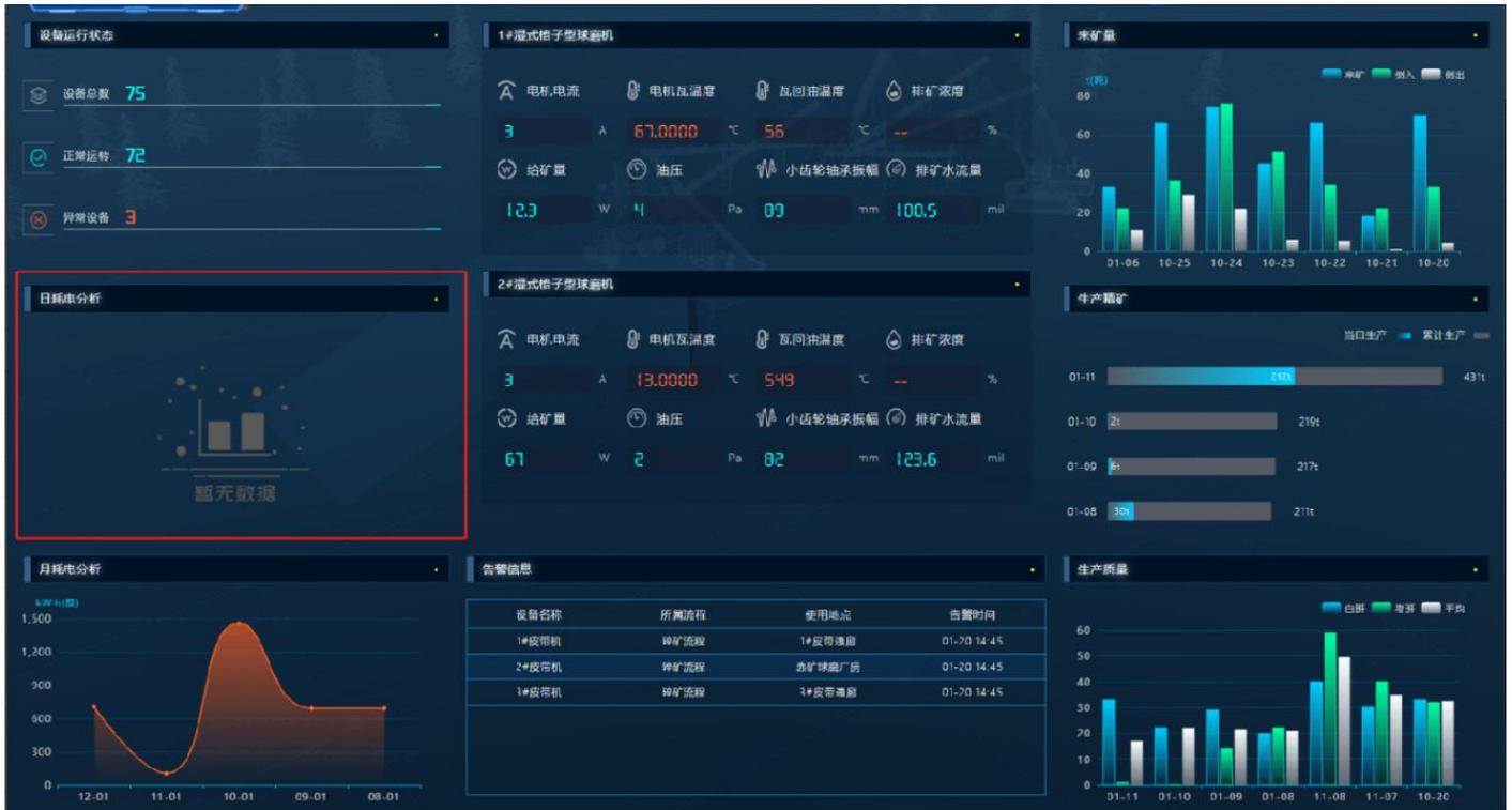
日耗电分析展示最近七天的耗电量曲线图，最近七天没有数据的时候会显示暂无数据。
