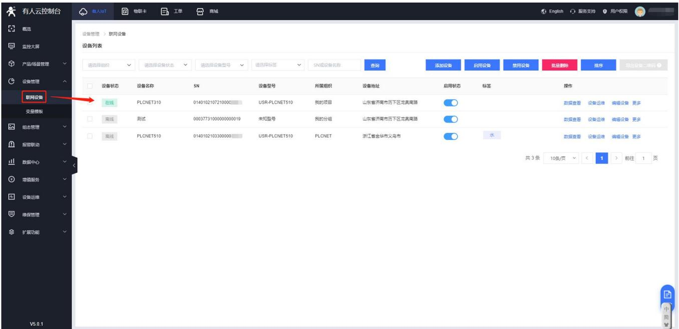
设备显示在线状态后，点击更多 同步按钮，云端会同步更新设备信息。
