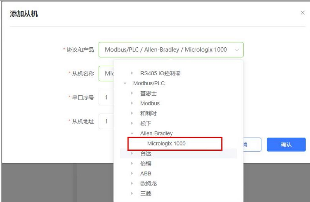
2. 选择连接 PLC 的串口号和 PLC 的站地址，输入错误可能导致采集失败。确认无误后点击确认即可。罗克韦尔通讯中存在主机号，目前默认 PLCNET310 的主机号为 0 且不可修改。
