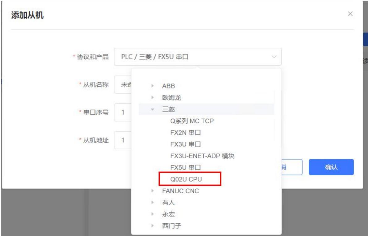
2. 选择连接 PLC 的串口号，输入错误可能导致采集失败。确认无误后点击确认即可。
