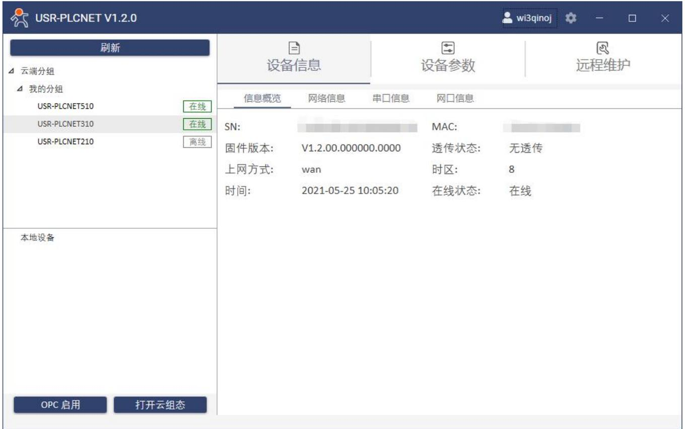
通过设备信息→网络信息，可以查看 PLCNET310 的服务器连接状态及上网方式。
