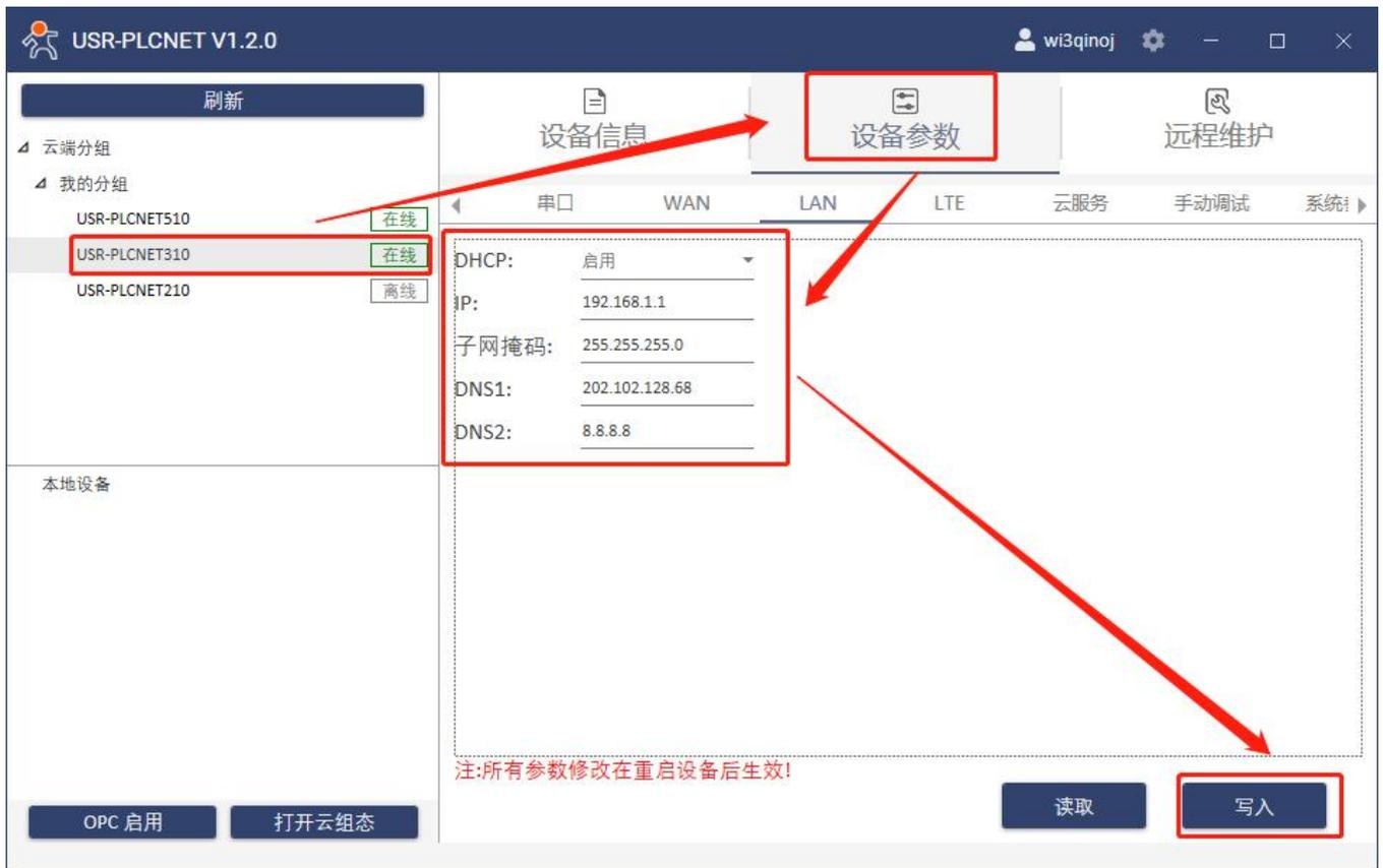
5. 三菱 Q PLC 通过网线连接至 PLCNET310 的 LAN 口，然后即可在云端查看 PLC 数据。
