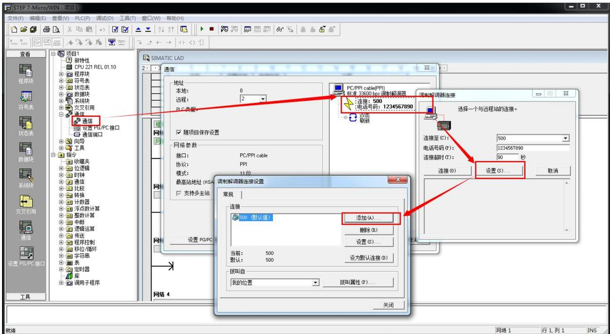
点击“添加”按钮，在弹出的对话框中输入连接名称，比如：USR-PLCNET310。本地调制解调器选择“标准 33600 bps 调制解调器”，然后勾选“这台调制解调器将使用偶校验（11 位组态）”和“将这台调制解调器用作移动电话调制解调器”。
