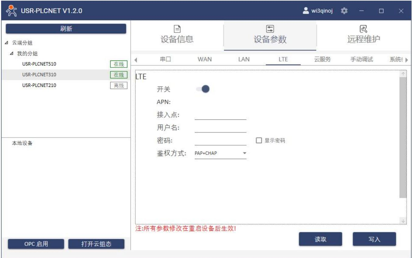
通过设备参数→云服务，可以读取 PLCNET310 的云端域名以及端口号，也可以进行相关参数的配置。
