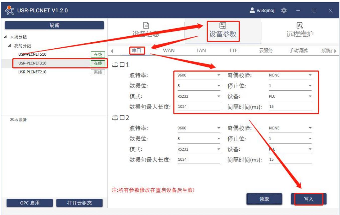
5. LK 系列 PLC 通过串口线连接至 PLCNET310，此时通过云端即可查看 PLC 数据。
