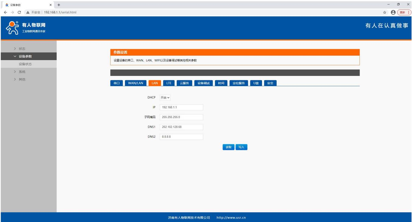
通过设备参数→设备状态→LTE，可以开启或者关闭 4G 联网以及 4G 相关参数。
