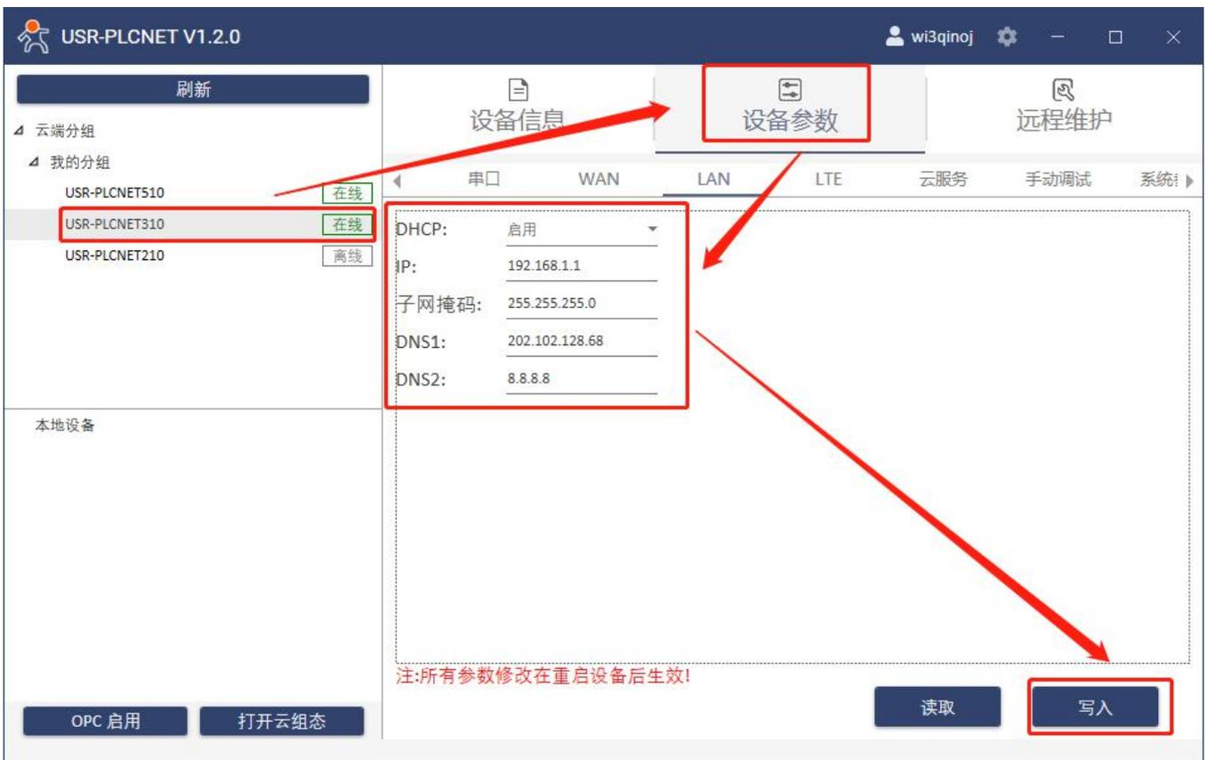
3. 通过网线连接 PLCNET310 的 LAN 口和 S7-700 触摸屏的网口。通过 USR-PlcNet 软件，开启网口透传。
