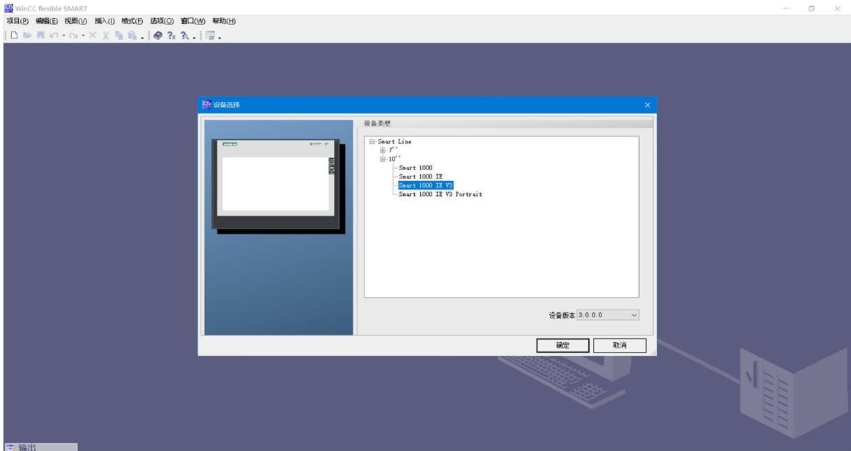
工程编译完成之后，将工程下载到 HMI。该处 IP 为 HMI 本机的 IP 地址，需保证和 PLCNET310 的 LAN 口处于同一网段。
