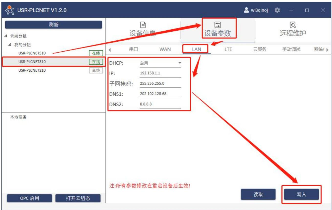
修改完成后在上位机中点击设备参数→系统参数→重启，设备重启后 LAN 口 IP 生效；也可右键单击设备选择“重启”以快速重启设备。
