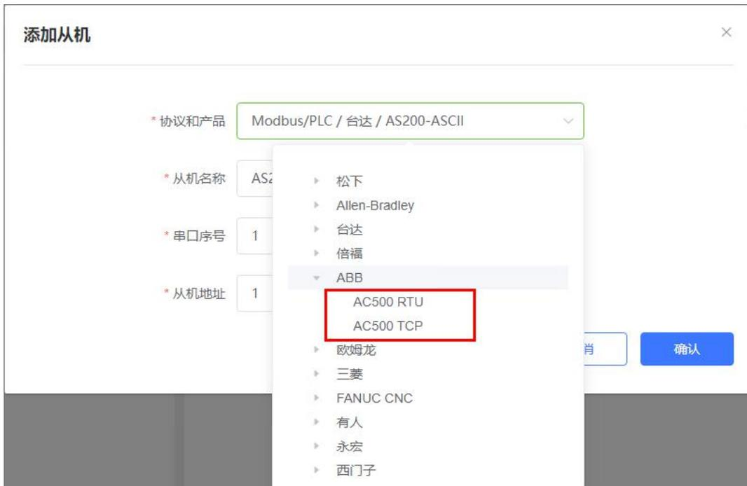
2. 选择连接 PLC 的串口号和 PLC 的站地址或者 IP 地址和端口号，输入错误可能导致采集失败。确认无误后点击确认即可。
