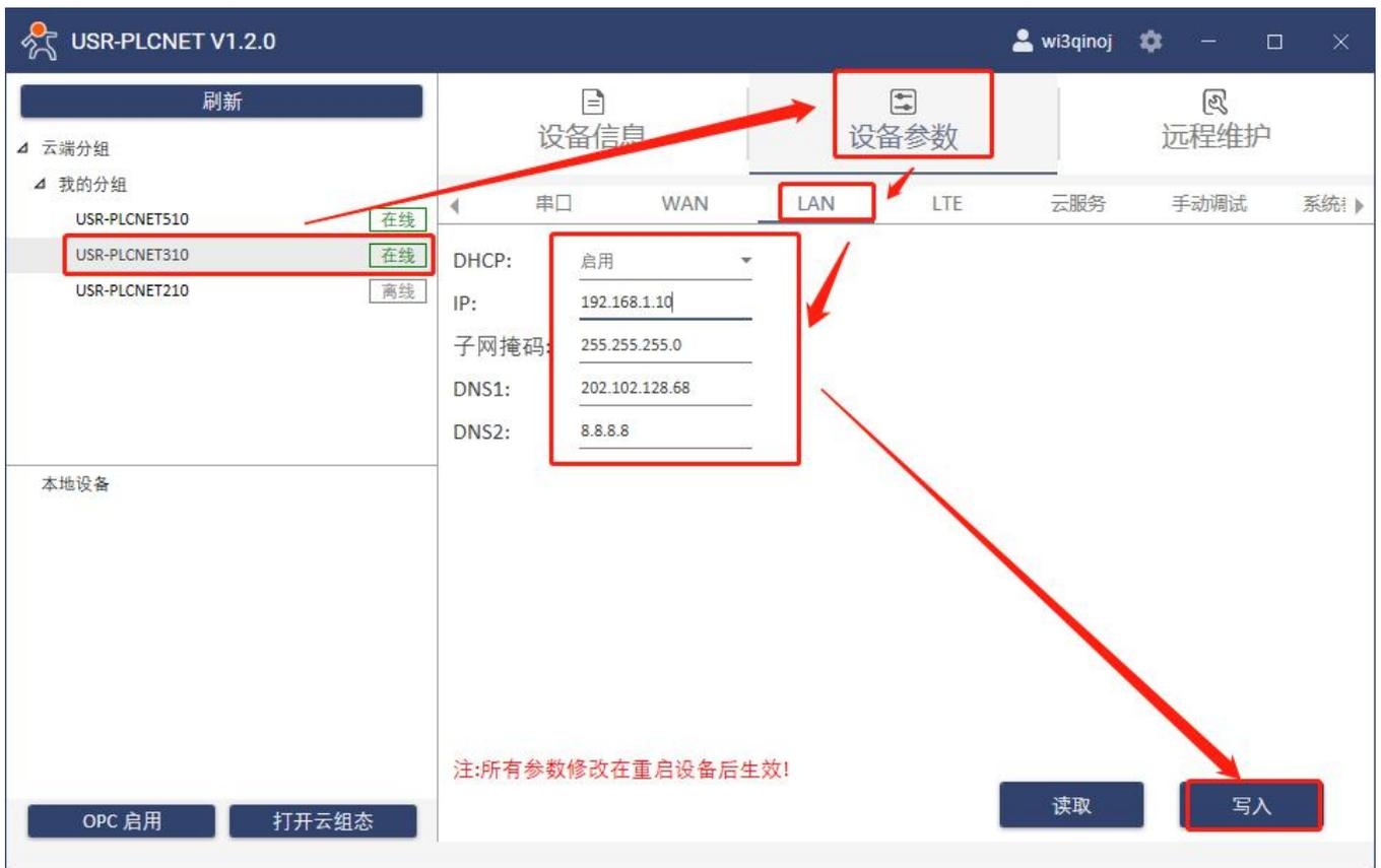
5. LK 系列 PLC 通过网线连接至 PLCNET310 的 LAN 口，然后即可在云端查看 PLC 数据。
