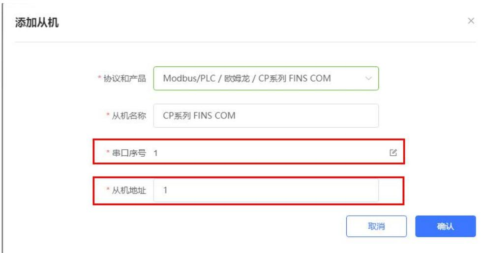
3. 添加需要采集的数据节点，注意 PLC 内部寄存器的实际地址范围，以及节点的读取方式。
