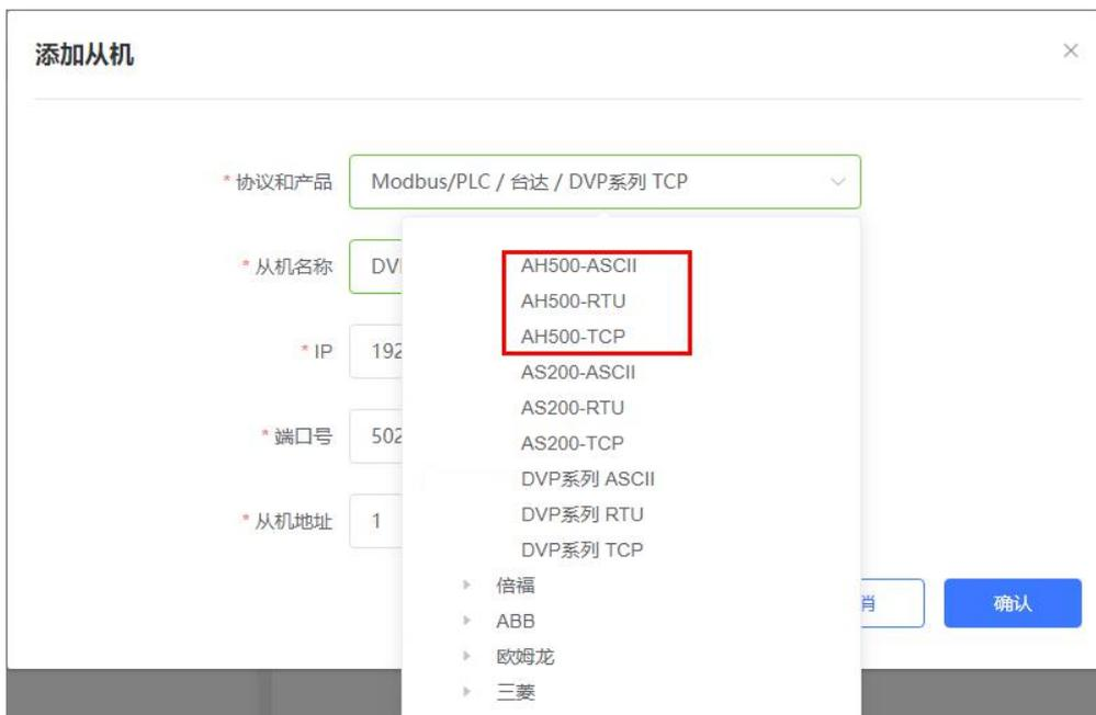
2. 选择连接 PLC 的串口号和 PLC 的站地址或者 PLC 的 IP 地址和端口号，输入错误可能导致采集失败。确认无误后点击确认即可。
