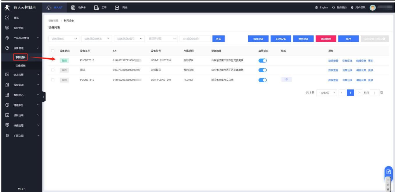
2. 修改 PLCNET310 的串口参数，和 PLC 串口参数保持一致。重启 PLCNET310 设备。
