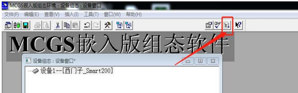
首先修改连接方式以及目标机 IP 地址，此 IP 地址对应 MCGS 触摸屏的 IP 地址，设置完成后，点击测试通信。如下所示则通信正常，可以正常下载程序了。
