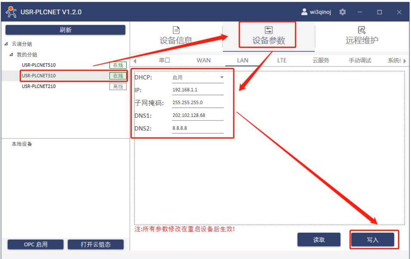
3. 通过网线连接 PLCNET310 的 LAN 口和 MCGS 的网口。通过 USR-PlcNet 软件，开启网口透传。
