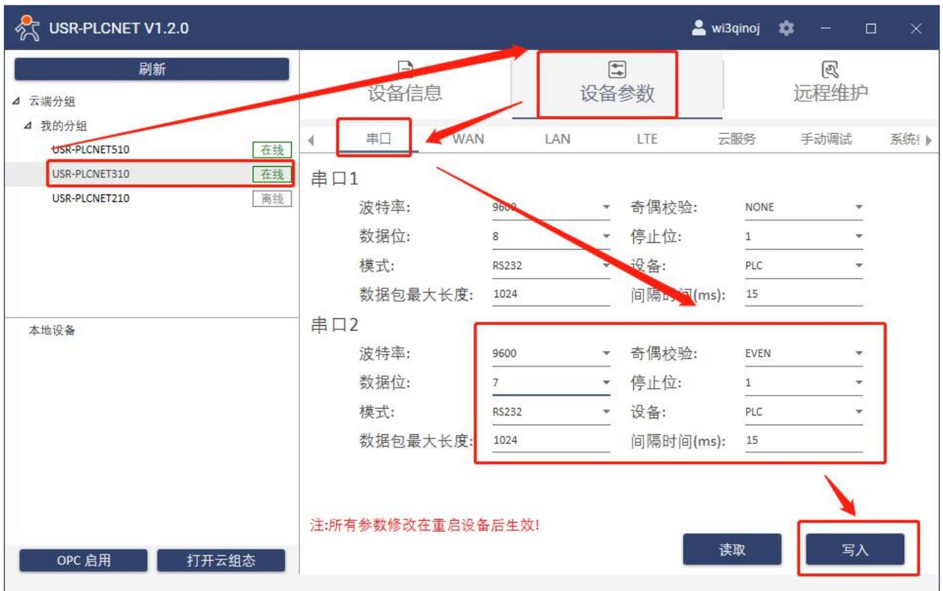
5. FBS-20MCT2-AC PLC 通过串口线连接至 PLCNET310，此时通过云端即可查看 PLC 数据。
