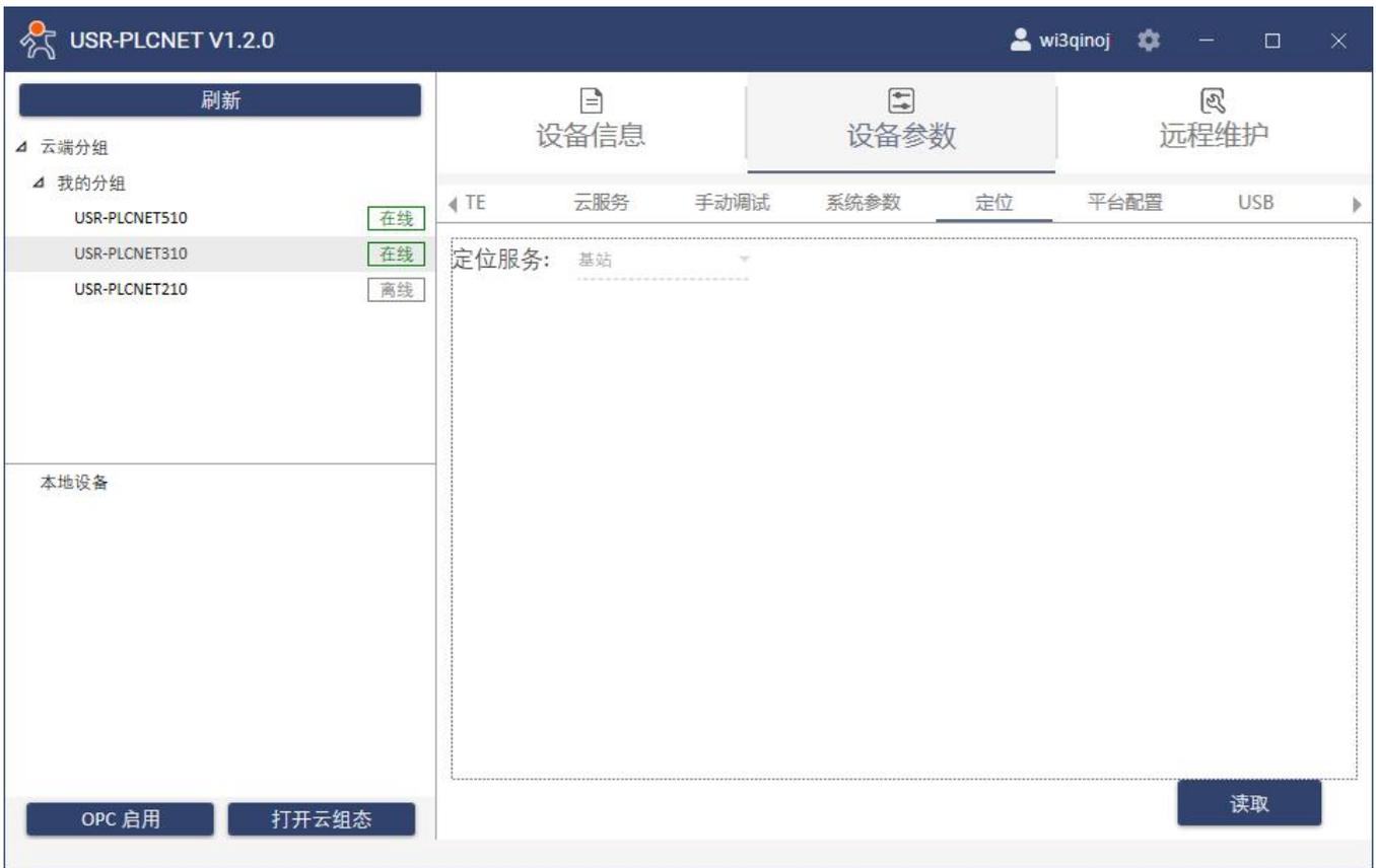
通过设备参数→平台配置，可配置 PLCNET310 连接私有云、阿里云、华为云和亚马逊云，四个通道独立配置，任意通道均可配置连接任意一个云平台。
