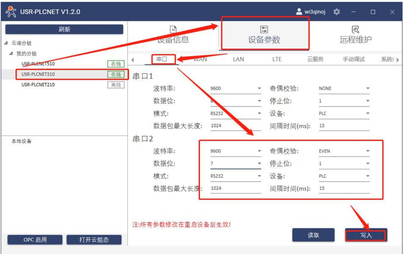
5. FP-X PLC 通过串口线连接至 PLCNET310，此时通过云端即可查看 PLC 数据。
