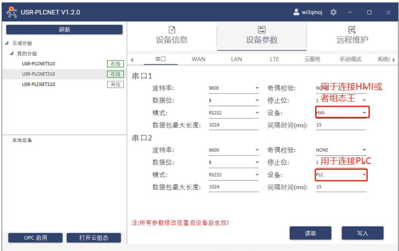
设置完成后点击写入，然后重启 PLCNET310。确保串口接线正确，即可从云端和组态王软件同时查看 PLC 数据。
