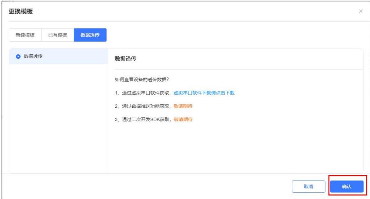
模板建立以后，选择保存，云端会主动向设备下发采集规则。确保 PLC 已经连接到网关，云端即可按照配置的数据模板采集 PLC 数据。
