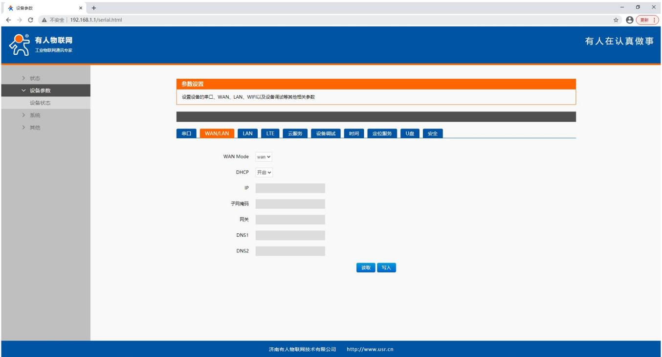
通过设备参数→设备状态→LAN，可以读取或者写入 PLCNET310 的 LAN 口参数。
