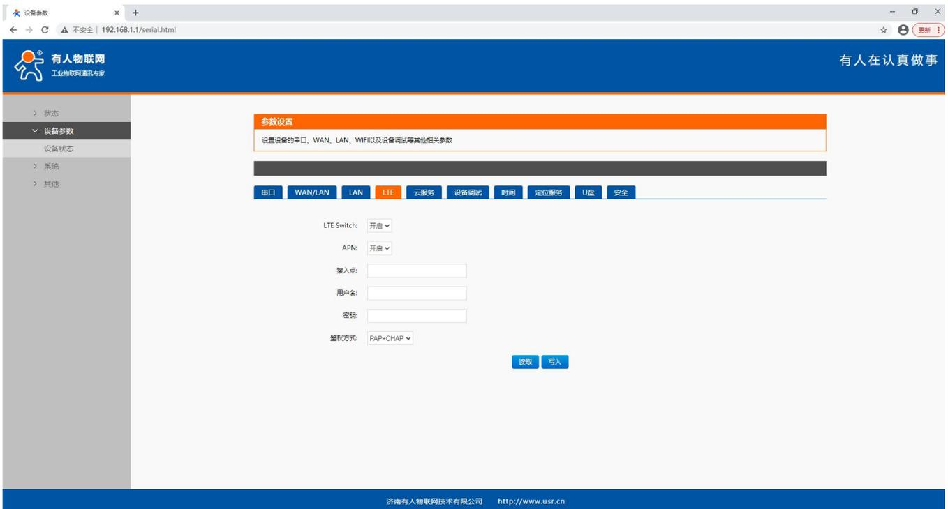
通过设备参数→设备状态→云服务，可以读取或者更改连接有人云服务器的域名和端口号。
