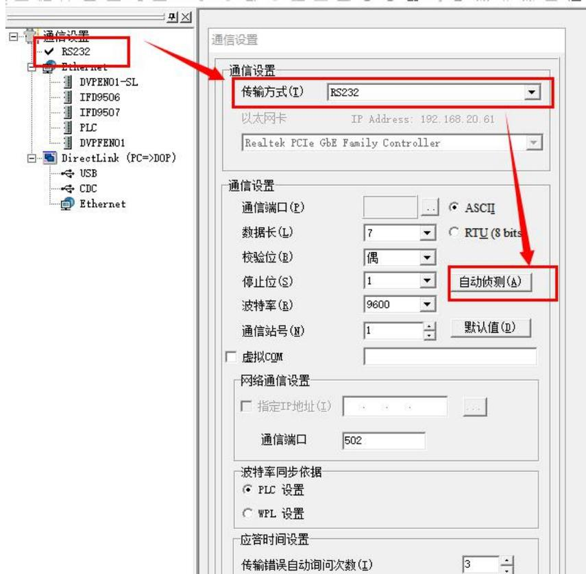
修改 PLC 的串口参数的方式为
