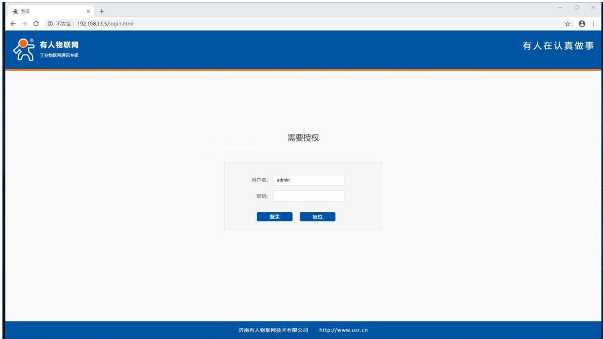
点击设备参数--设备状态--LAN，修改 IP 和网关，点击写入，然后重启设备。
