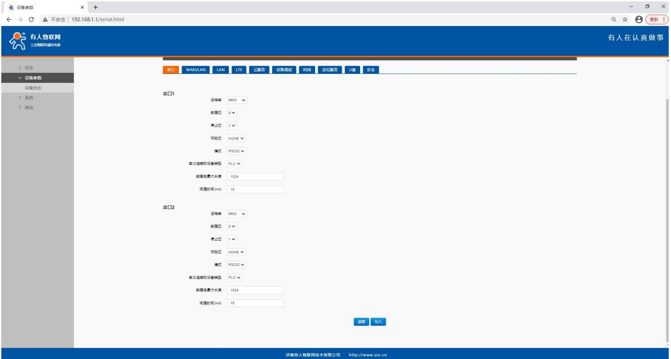
通过设备参数→设备状态→WAN/LAN，可以读取或者写入 PLCNET310 的 WAN/LAN 口参数。
