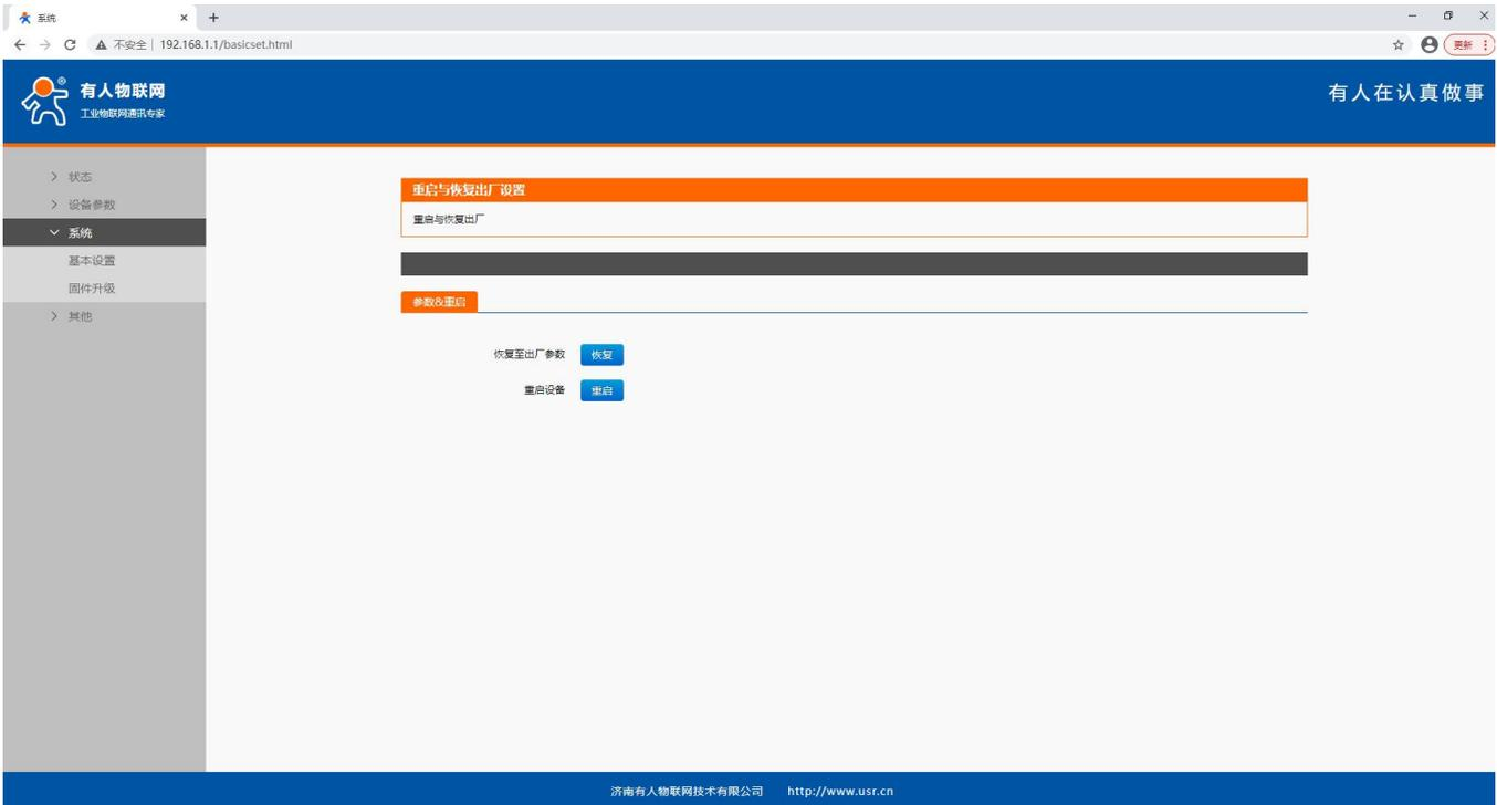
通过系统→基本设置→固件升级，可以对 PLCNET310 进行固件升级。
