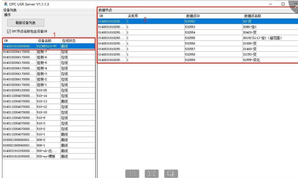
如下所示的选项可以使添加数据节点时可以显示节点所属设备的 SN。
