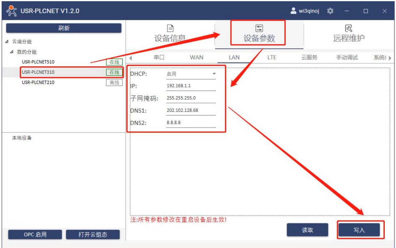
3. 通过网线连接 PLCNET310 的 LAN 口和 GP-4402 的网口。通过 USR-PlcNet 软件，开启网口透传。
