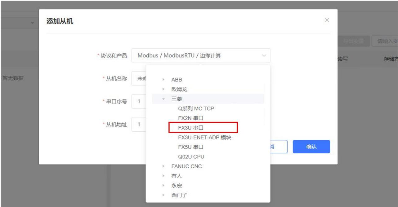
2. 选择连接 PLC 的串口号，输入错误可能导致采集失败。确认无误后点击确认即可。
