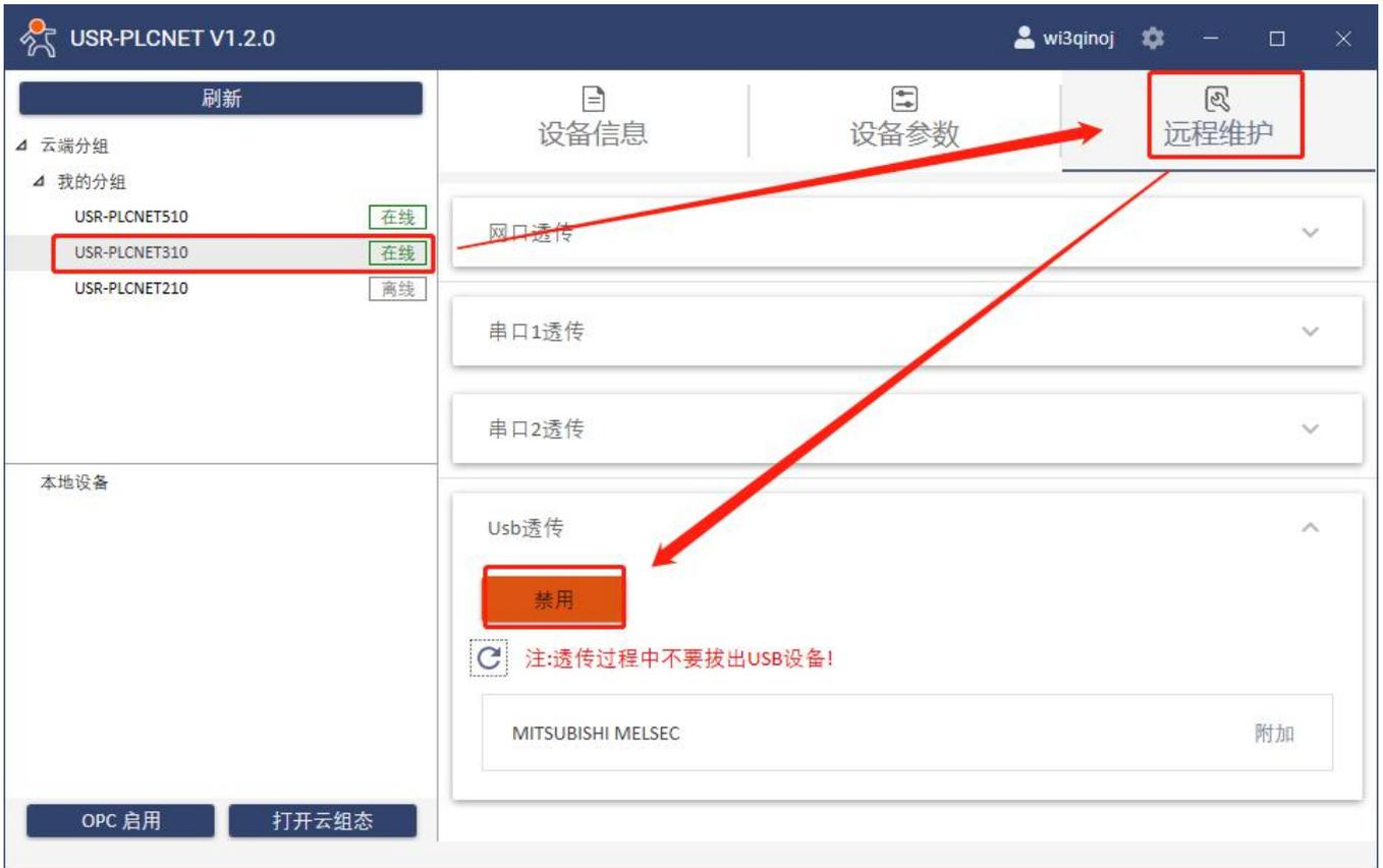
3. USB 透传开启后，点击刷新按钮，将所有接入 PLCNET310 的 USB 设备显示出来，选择设备进行附加操作。
