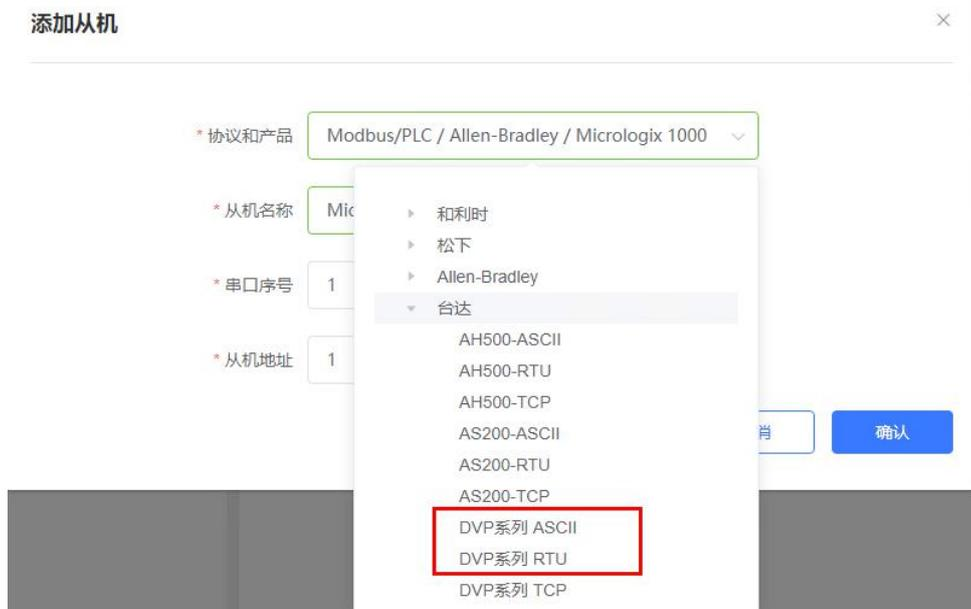
3. 选择连接 PLC 的串口号和 PLC 的站地址，输入错误可能导致采集失败。确认无误后点击确认即可。
