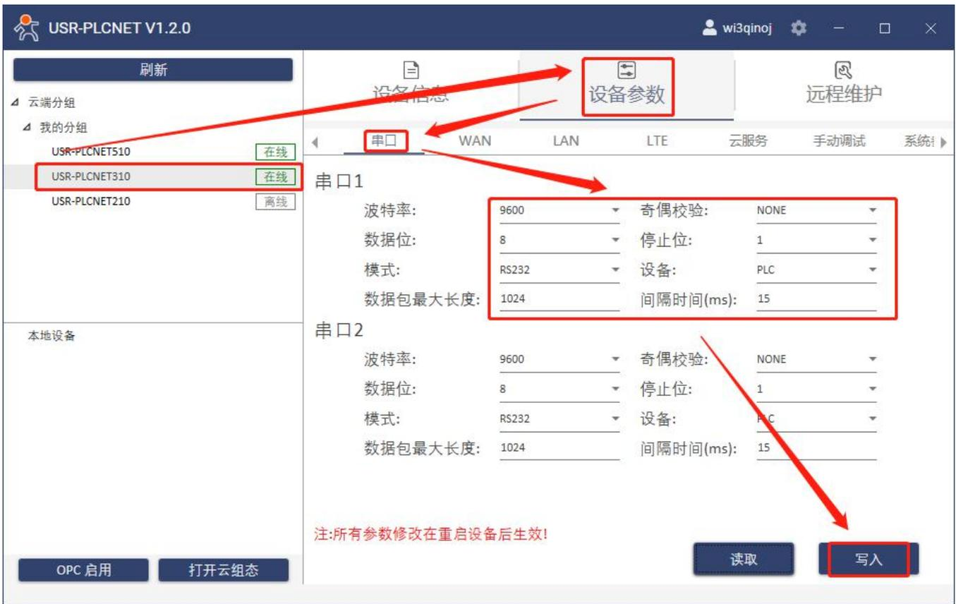
5. MicroLogix PLC 通过串口线连接至 PLCNET310，此时通过云端即可查看 PLC 数据。
