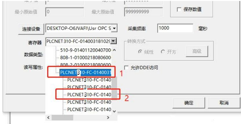
图中框 1 表示该 OPC 账号下的设备名称，因在 OPC 软件内勾选了 OPC 节点名称包含设备 SN 选项，所以本示例的设备名称以及节点都包含设备的 SN 码。双击设备名称可以显示框 2 表示的设备包含的节点信息，点击此节点信息即可将此节点添加到组态王软件的寄存器下，此时组态王的这个节点便和有人云端的同名称节点关联，以此可以实现云端和组态设备同时监控。
