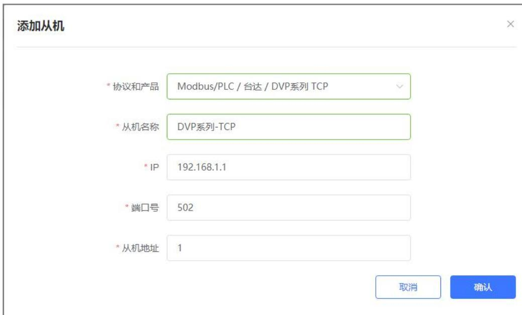
3. 添加需要采集的数据节点，注意 PLC 内部寄存器的实际地址范围，以及节点的读取方式。
