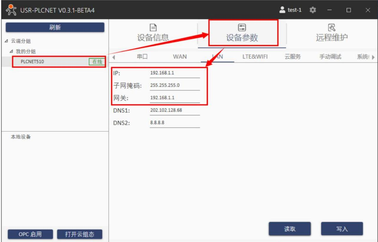
5. S7-1200 通过网线连接至 PLCNET310 的 LAN 口，即可在云端设备列表查看 PLC 数据。
