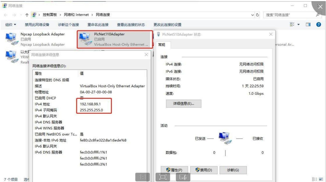
此网卡是 PLCNET310 自动分配的，和 PLC 处于同一个网段，相当于和 PLC 网线直连。
