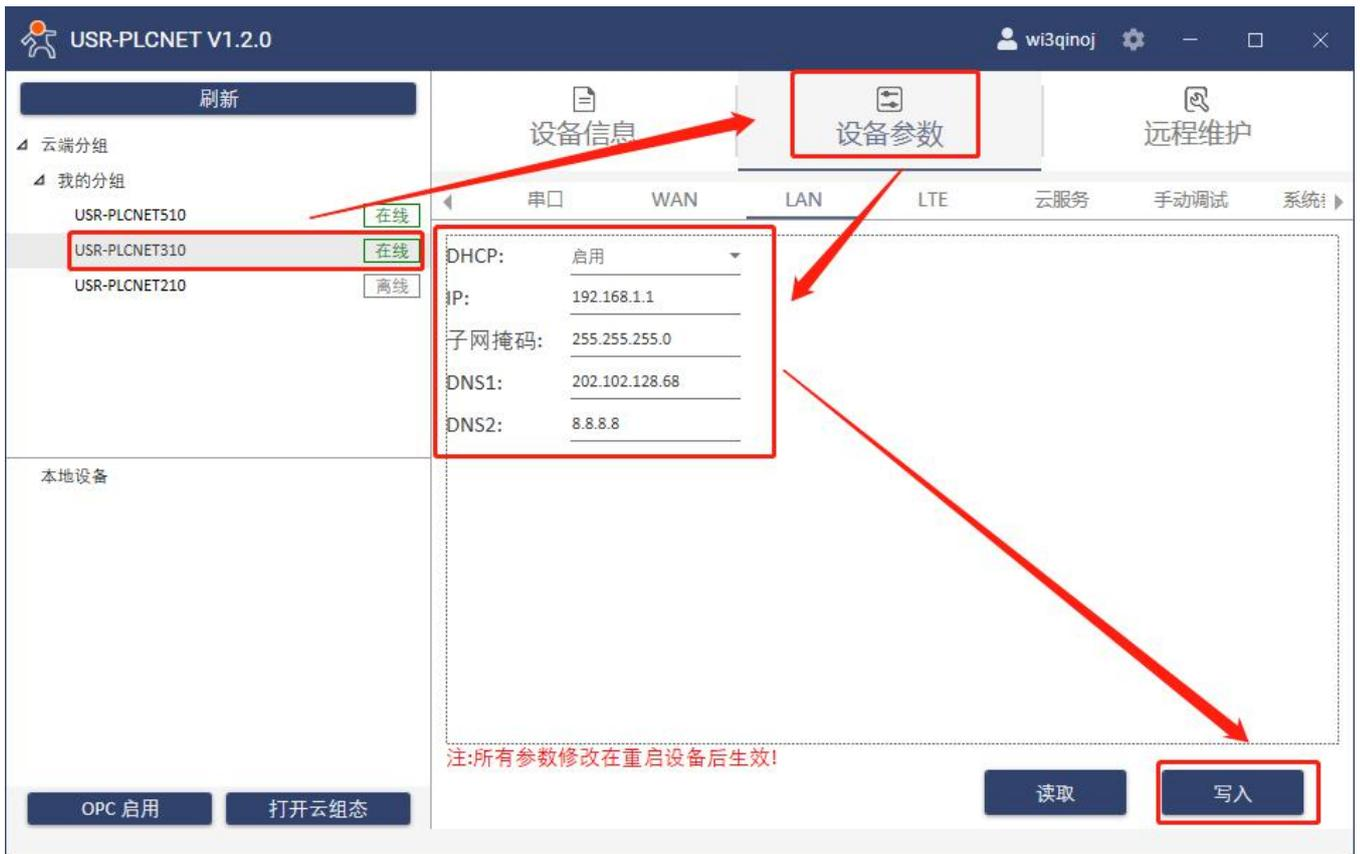
5. S7-200 Smart 通过网线连接至 PLCNET310 的 LAN 口，然后即可在云端查看 PLC 数据。
