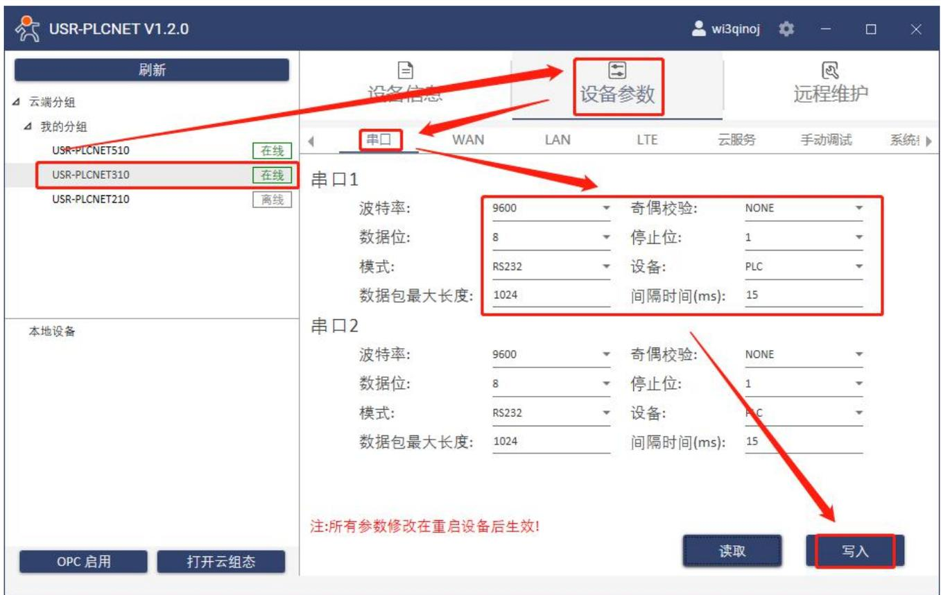
5. LM 系列 PLC 通过串口线连接至 PLCNET310，此时通过云端即可查看 PLC 数据。
