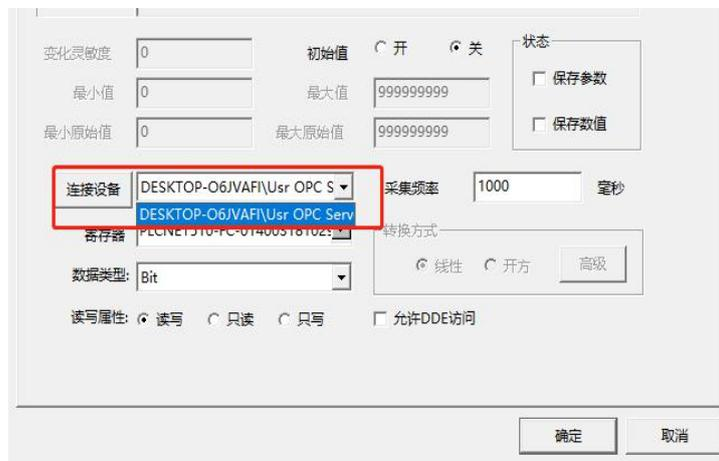
变量的寄存器为 OPC 下的一个设备，双击此设备可以显示出该设备在有人云端添加的采集模板下的节点信息，通过点击这些节点信息将节点添加到组态王的寄存器，具体如下：
