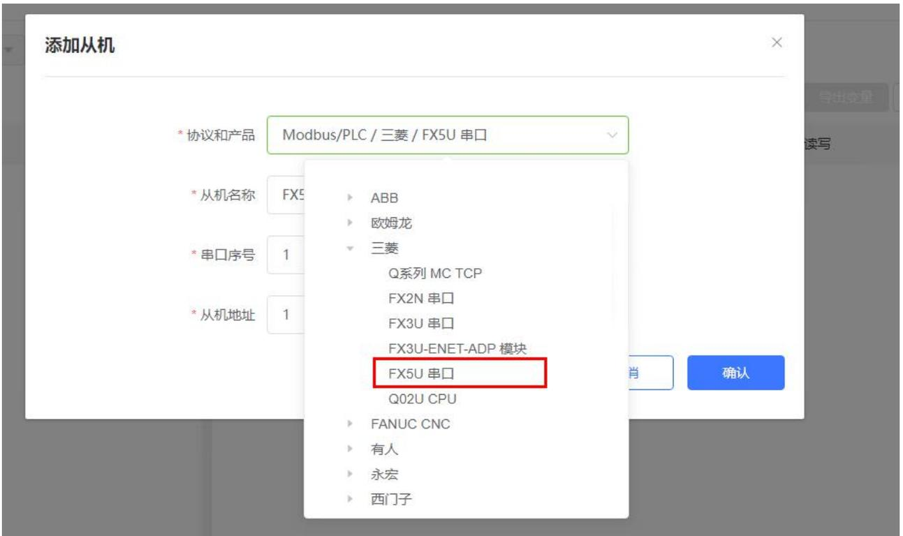
2. 选择连接 PLC 的串口号，输入错误可能导致采集失败。确认无误后点击确认即可。
