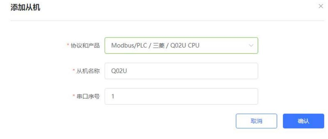
3. 添加需要采集的数据节点，注意 PLC 内部寄存器的实际地址范围，以及节点的读取方式。
