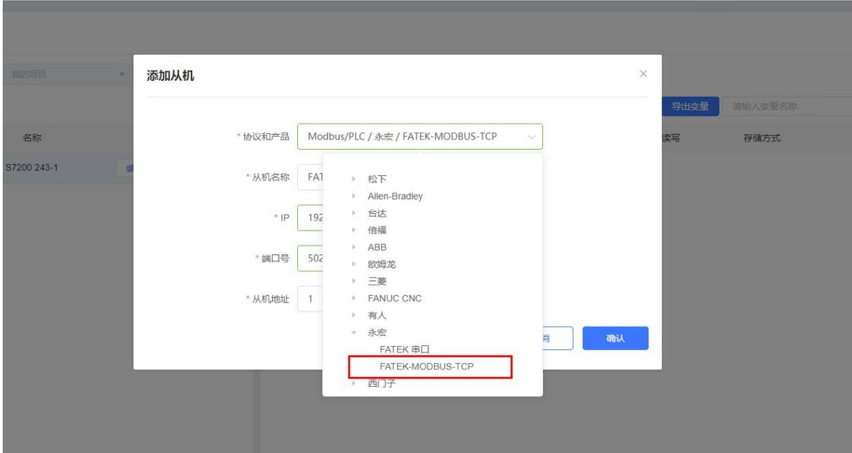
2、选择连接 PLC 的 IP 地址和端口号和 PLC 的站地址，输入错误可能导致采集失败。确认无误后点击确认即可。
