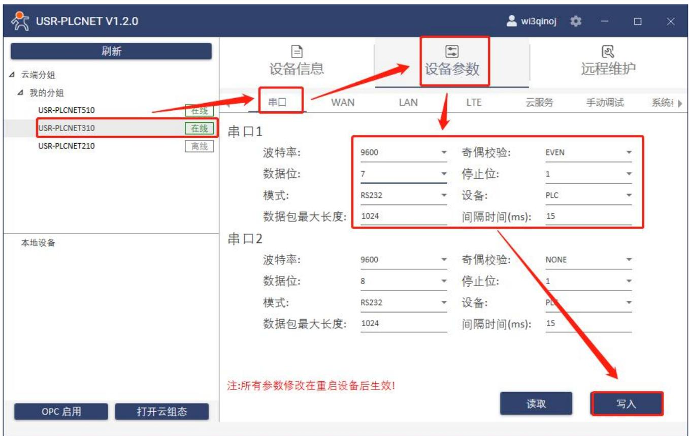
5. FX5U 通过串口线连接至 PLCNET310，此时通过云端即可查看 PLC 数据。
