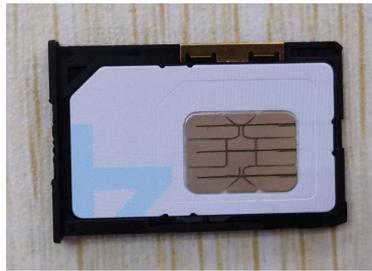
设备插入 SIM 卡，即可通过 4G 联网。若需要关闭 4G 上网，可以通过内置网页或者 USR-PlcNet 软件进行操作。具体操作方法，请参考下图。
