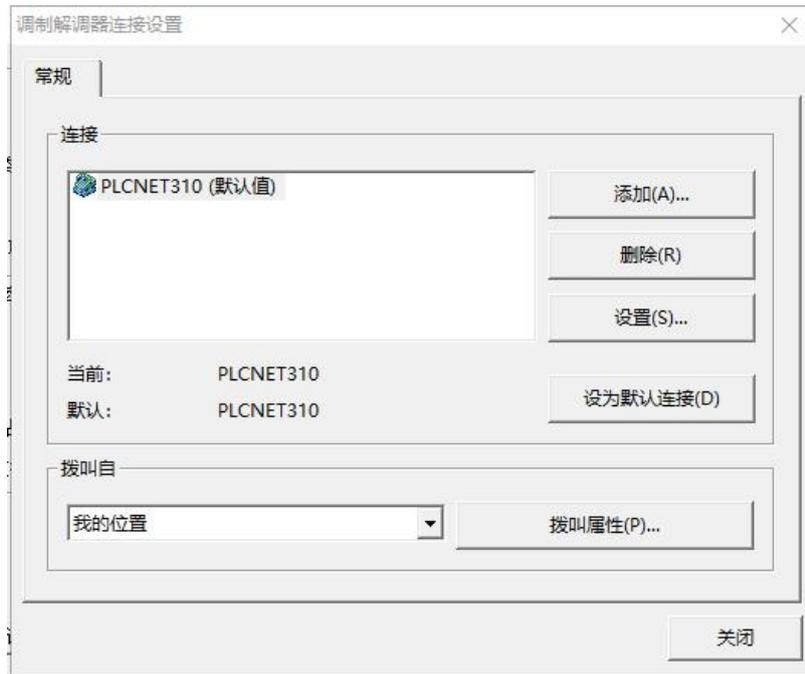
点击连接，完成软件与调制解调器的连接；连接完成之后此页面自动关闭；
