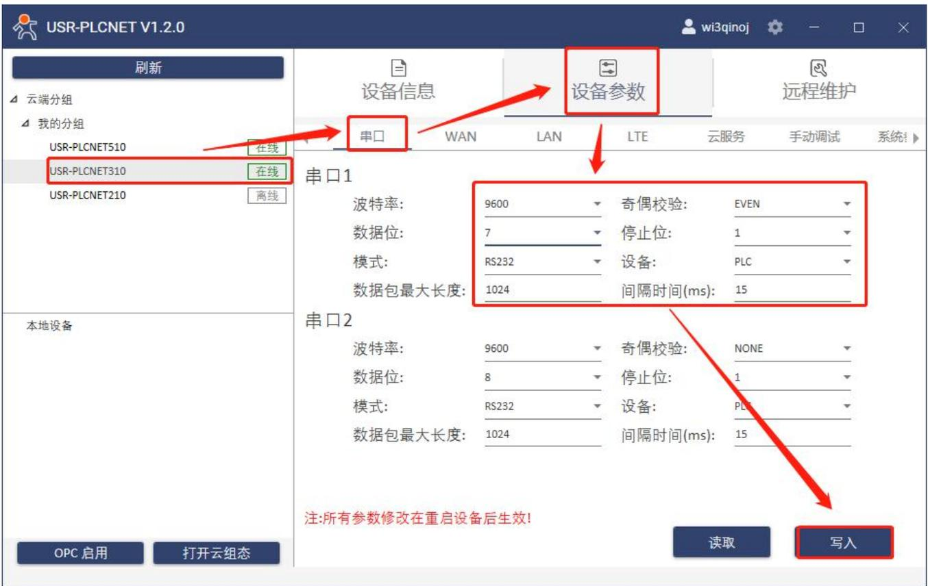
8. S7-200 PLC 通过串口线连接至 PLCNET310，此时通过云端即可查看 PLC 数据。
