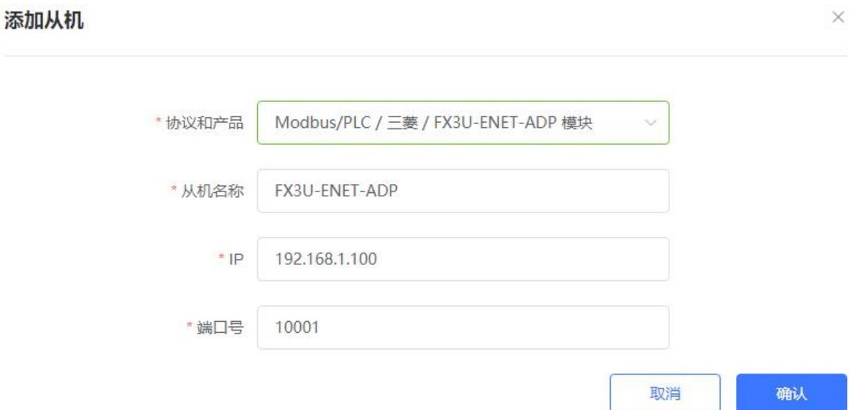
3. 添加需要采集的数据节点，注意 PLC 内部寄存器的实际地址范围，以及节点的读取方式。
