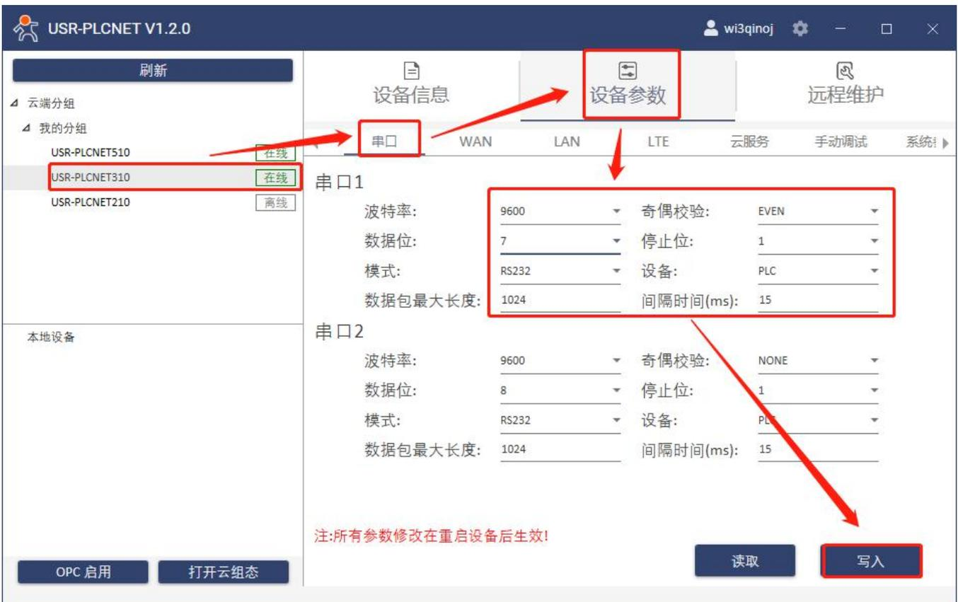
5. FX3U 通过串口线连接至 PLCNET310，此时通过云端即可查看 PLC 数据。
