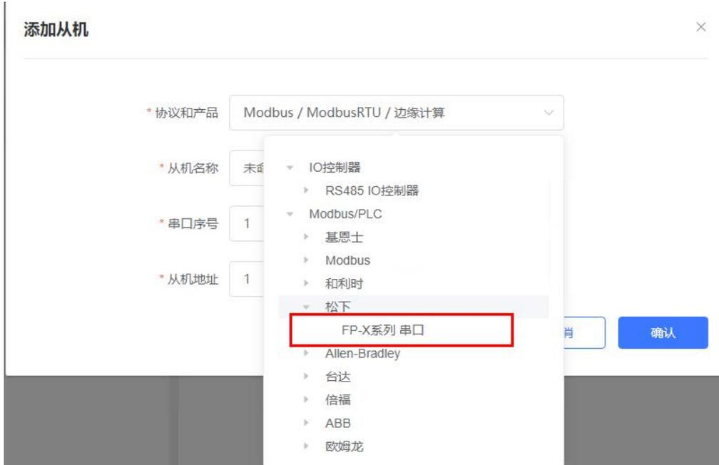
2. 选择连接 PLC 的串口号和 PLC 的站地址，输入错误可能导致采集失败。确认无误后点击确认即可。
