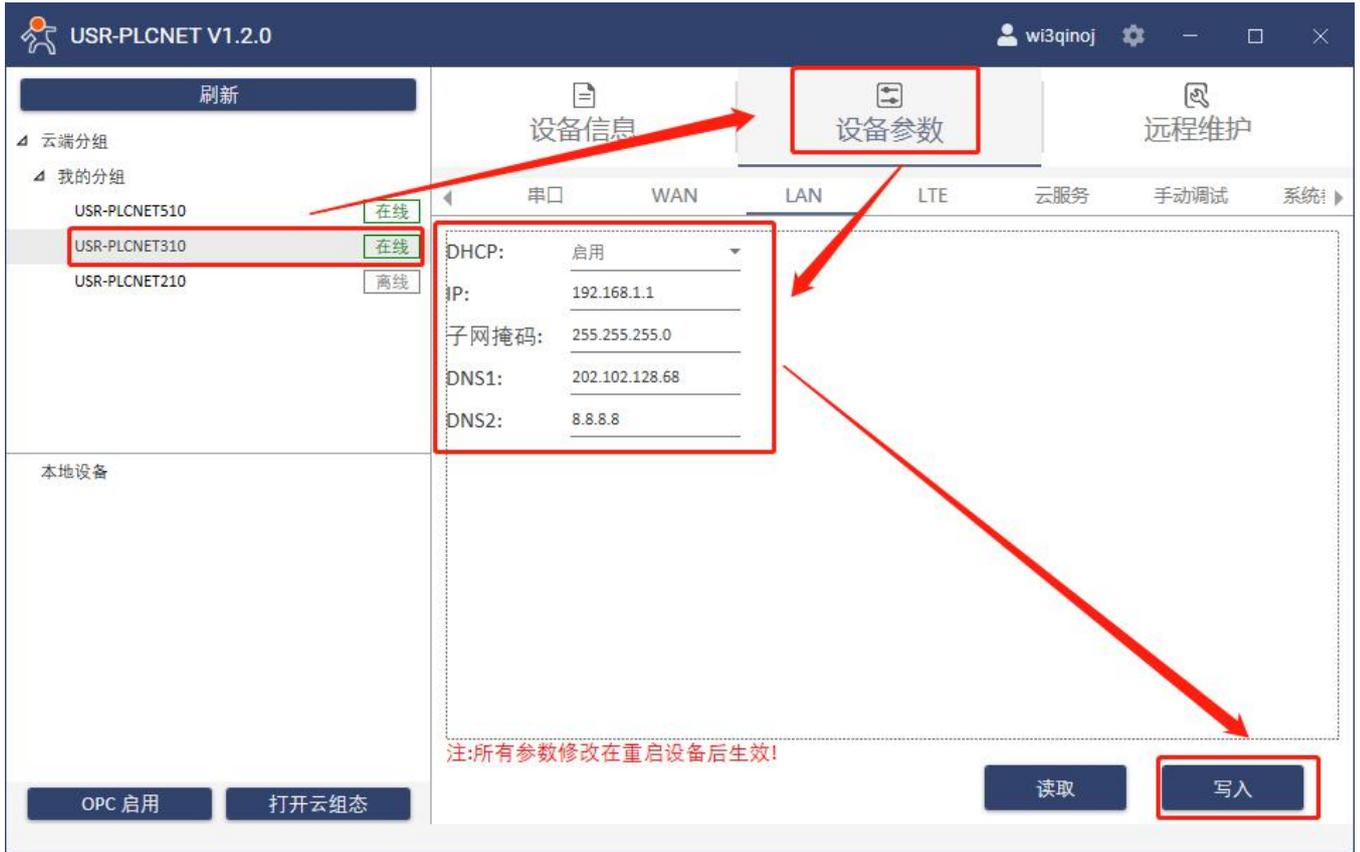
5. 台达 PLC 通过网线连接至 PLCNET310 的 LAN 口，然后即可在云端查看 PLC 数据。
