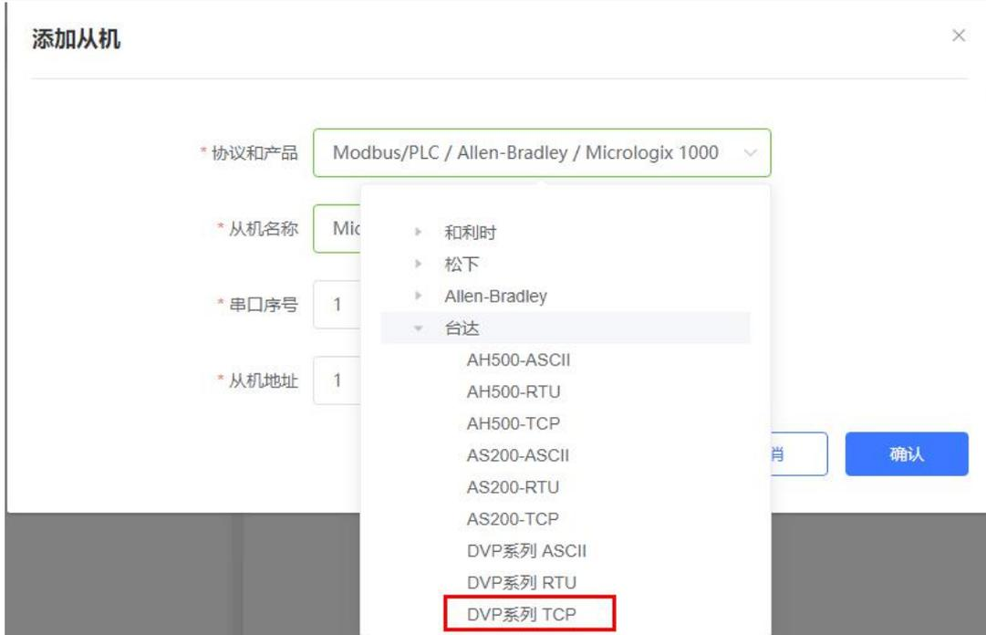
2. 设置 PLC 的 IP 地址以及端口号，输入错误可能导致采集失败。确认无误后点击确认。
