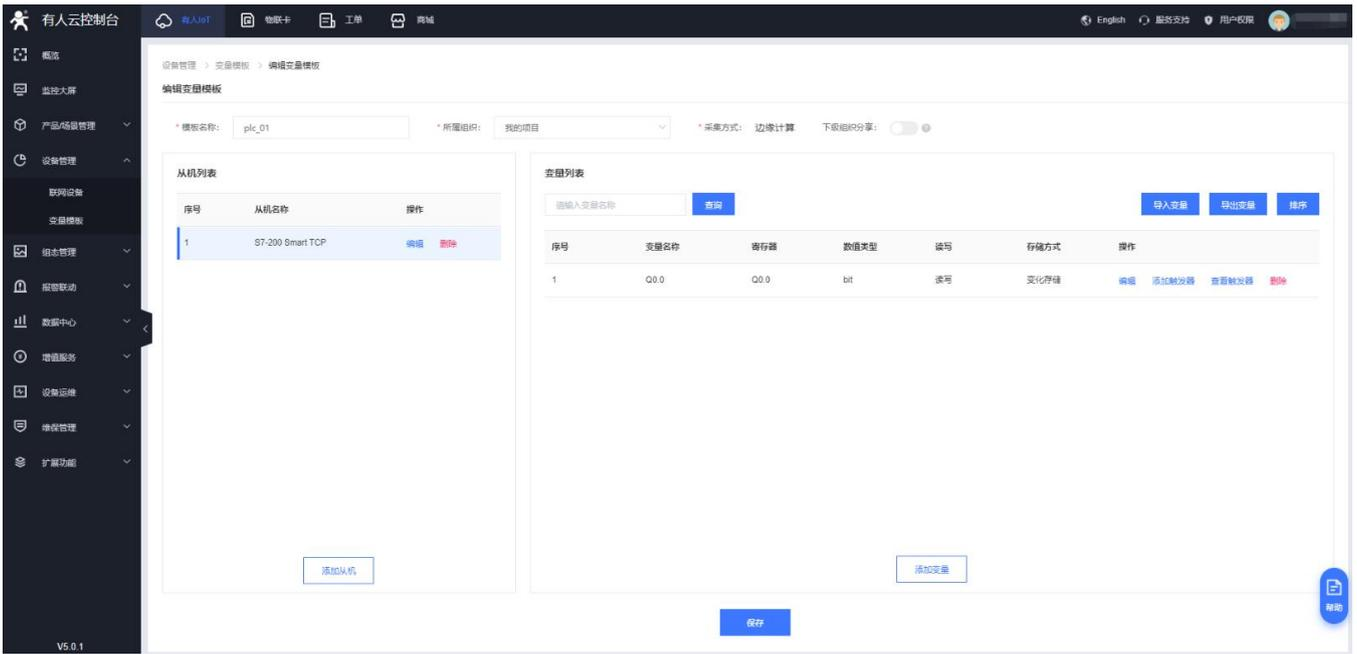
4. 修改 PLCNET310 的 LAN 口参数，使得 LAN 口和 S7-200 Smart 的网口处于同一个网段，设置完成后重启网关设备。
