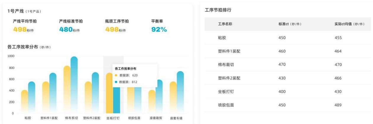
通过周期工序数据的积累，也可以按照工序节拍的数据表现，绘制各工序数据的实际范围，以及工序间节拍的比重，辅助产线管理人员了解真实产线中，各工序的节拍情况，结合工序表现辅助制定工序标准以及对工序做结构化升级
