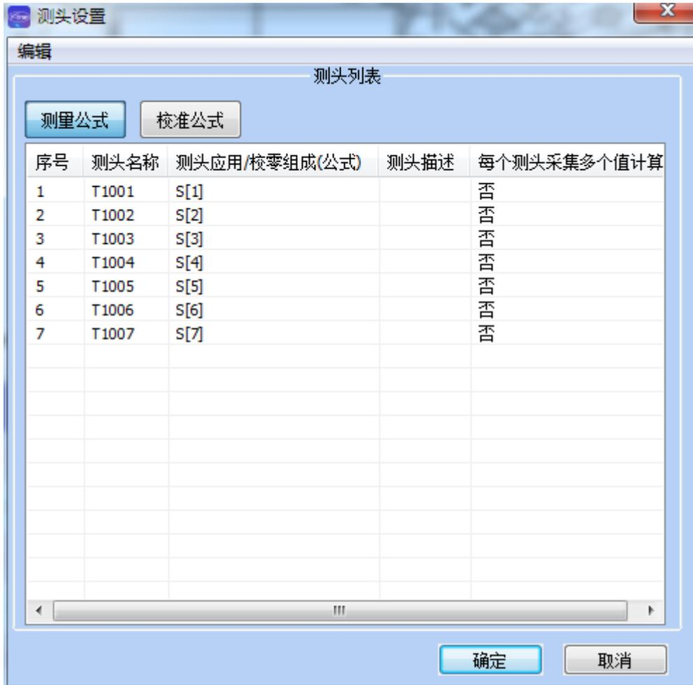
④. 选择“校准公式”后，编辑的测头为校准时使用的测头。校准时优先使用校准公式，如果测头没有校准公式，则使用测量公式进行校准。
