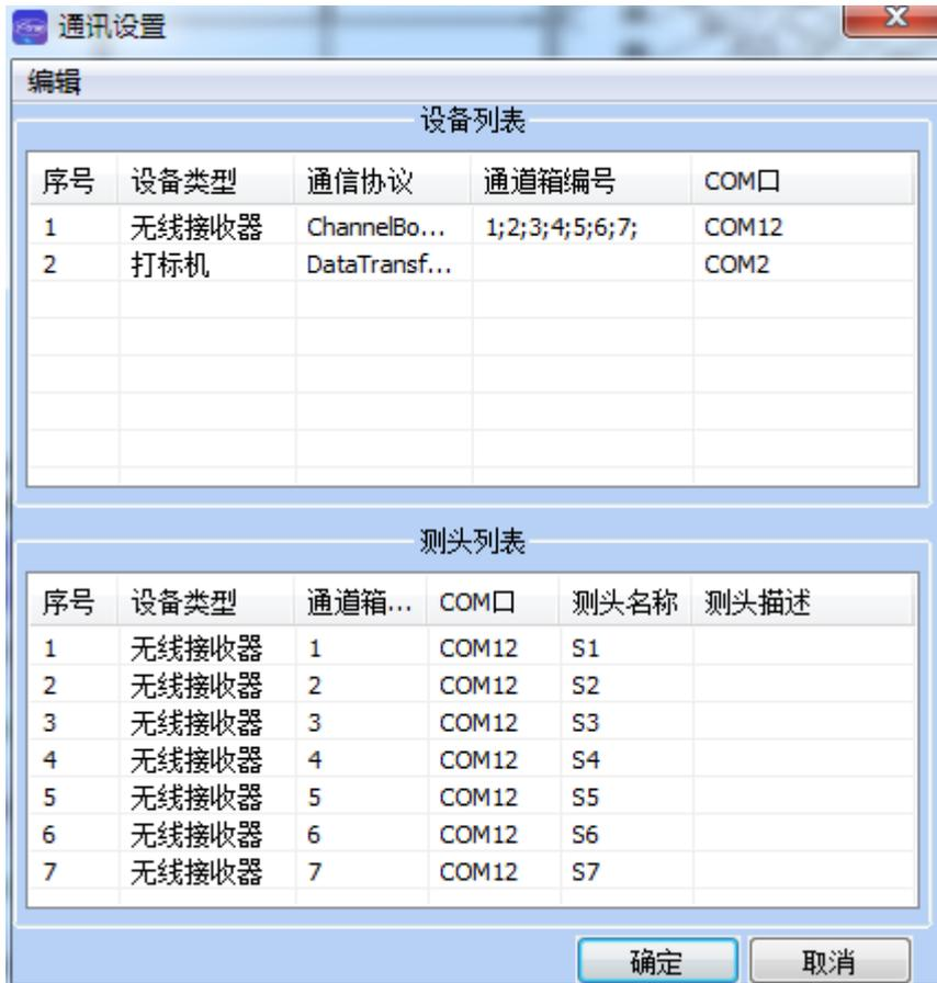
②. 点击编辑添加，输入设备信息、选择通讯协议后确定。支持配置通讯参数和自定义起始符号和结束符号。用户可以自定义设备类型名称。
