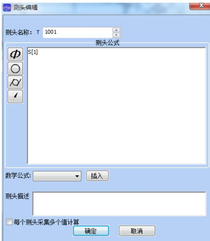
③. 虚拟测头之间的调用遵循“自前向后”原则，任何测头的组成必须是编号小于本身并且真实声明的测头（比如：测头 T1013 应该由编号小于 1013 的测头组成）。
