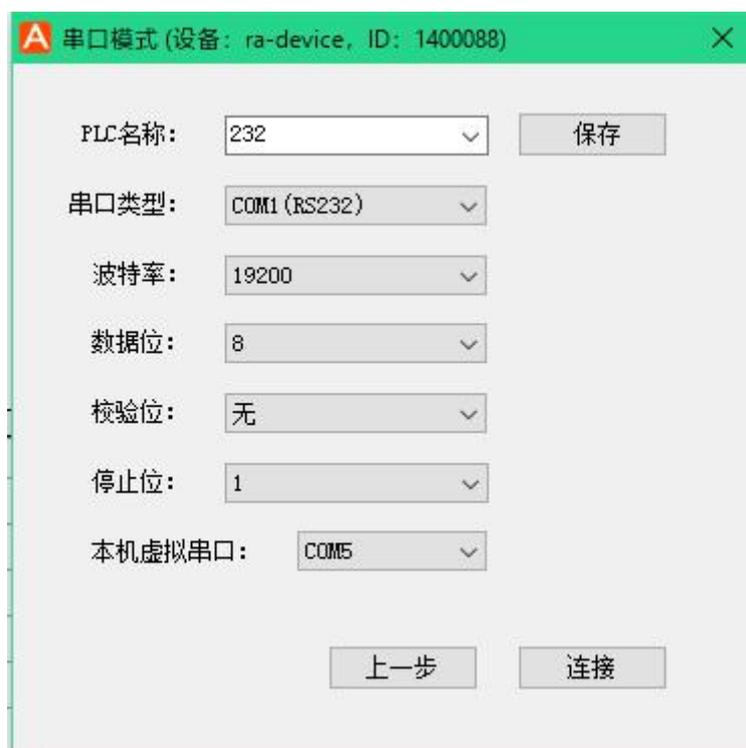
图 3-3-2-2-2 串口连接参数配置
