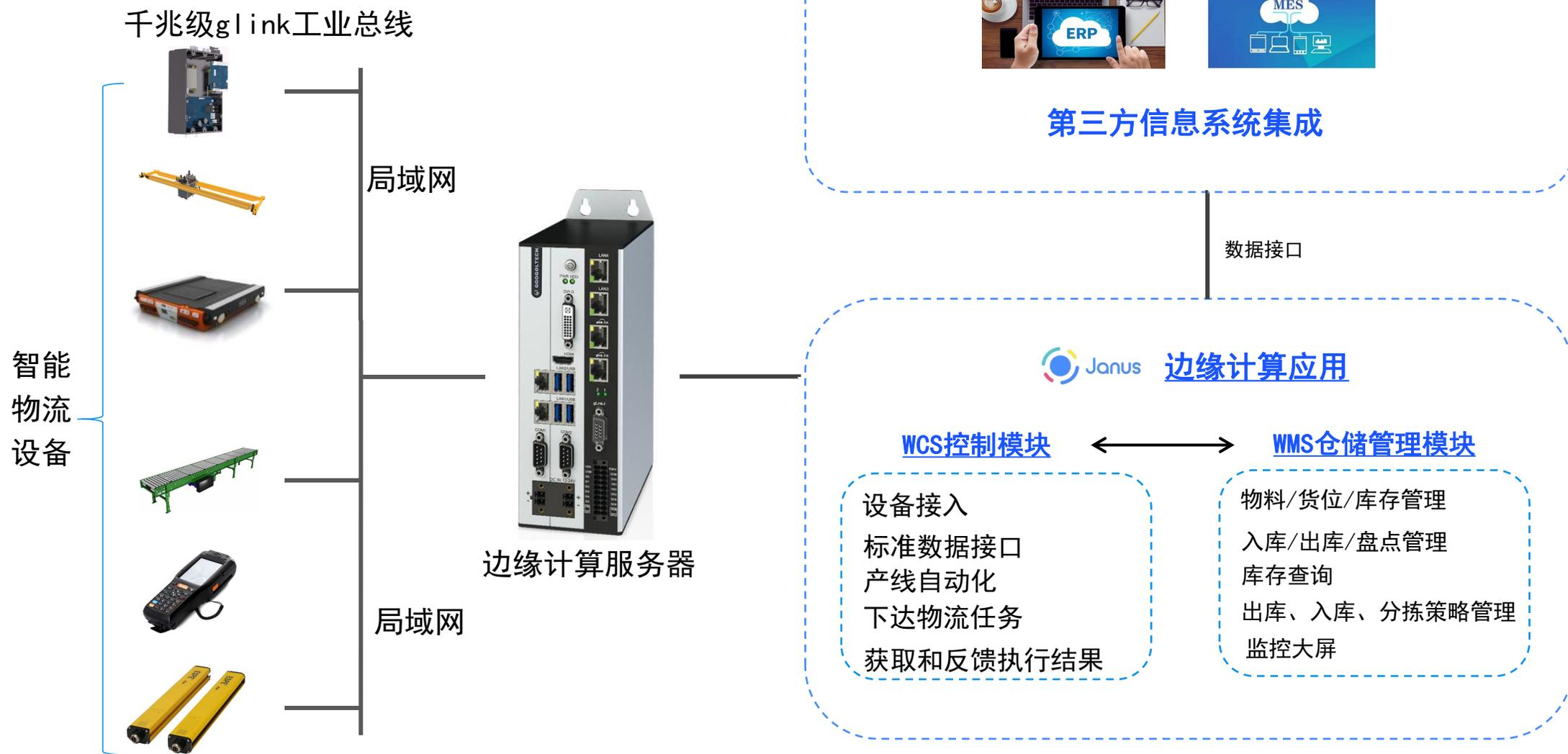
智能物流仓储管理系统基于Janus边缘计算系统，从仓库管理和仓库智能调度两个场景出发，开发了两大功能模块：WMS（Warehouse Management System）仓储管理模块，WCS（Warehouse Control System）仓储控制模块。
