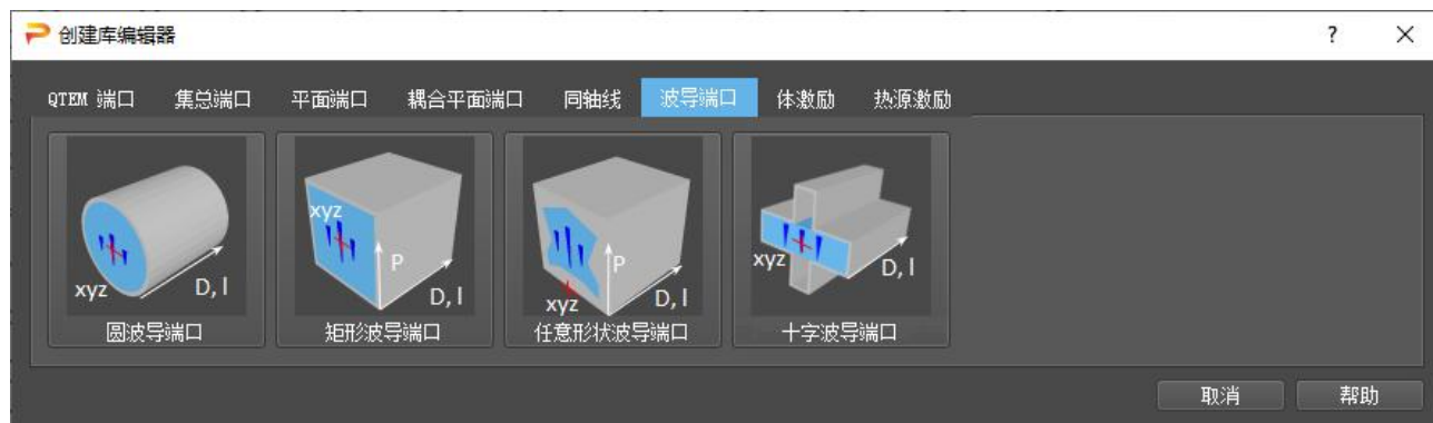
图 9.10 波导端口类型
