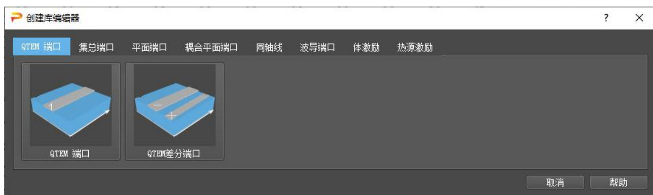
图 9.2 QTEM 端口类型
