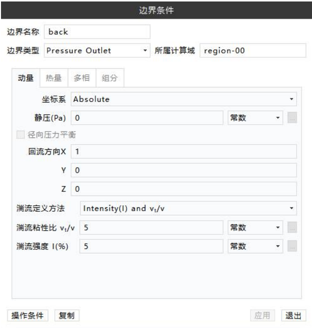
图 248 buildings 边界条件设置图：Pressure Outlet
