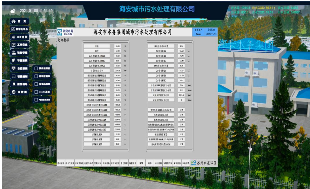
图 8-3 电力监测系统
