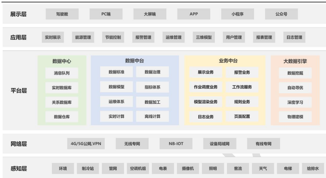
图 1 建筑物联网数据中台体系
