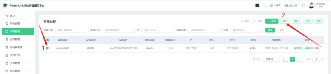
删除：勾选已创建的容器，点击“删除”弹出删除确认框，点“确定”对指定容器进行删除，如图所示：
