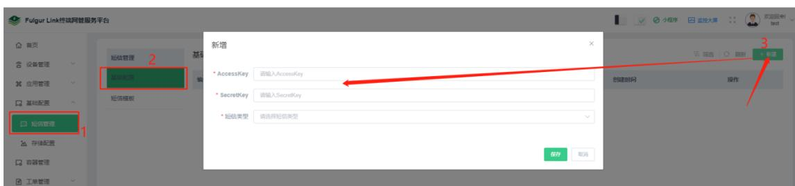
选择“短信管理”--->短信模板--->新建，在新建弹窗中，根据实际情况，按照页面提示填写信息，然后点击“保存”完成操作，如下图所示：
