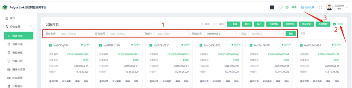
重启设备：选择设备，点击“重启设备”按钮，弹出重启设备窗口，并在确认弹窗中点击“重启”，设备将远程进行重启，如图所示：
