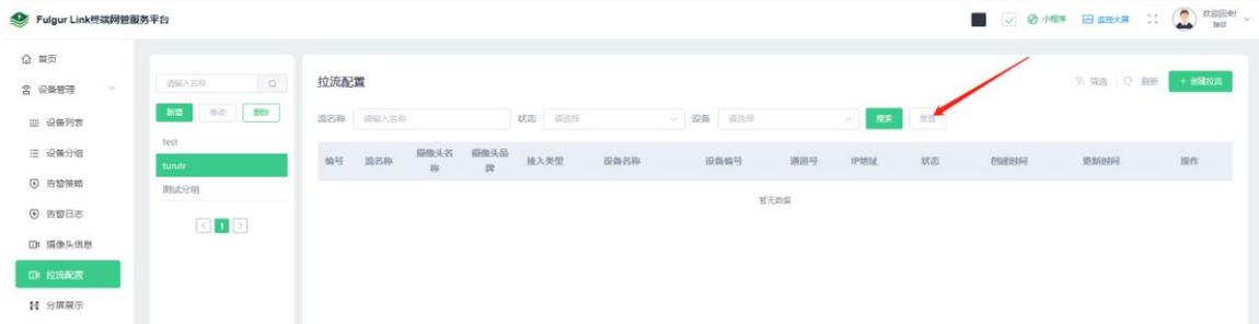
创建拉流：在拉流配置菜单栏中选择想添加拉流的分组--->点击“创建拉流”，填写创建拉流配置项，点击“保存”，提示“添加成功”完成对拉流配置的添加操作，如图所示：
