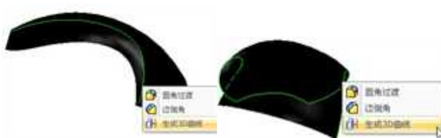
图 5-24 由实体边界生成 3D 曲线
