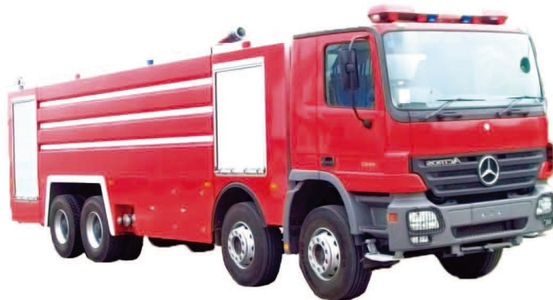
大功率水罐泡沫消防车
