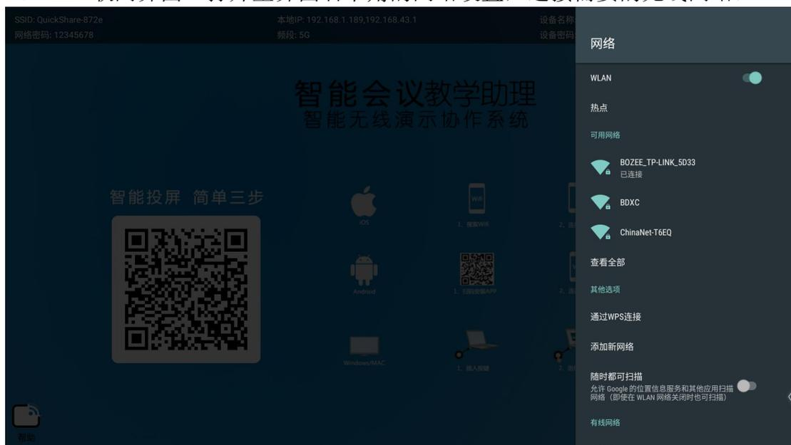
2、3288 联网界面。长按主界面右下角的两个应用图标中的其中一个，在弹出的应用列表中选择系统设置，点击系统设置，进入下图界面，打开无线设置：
