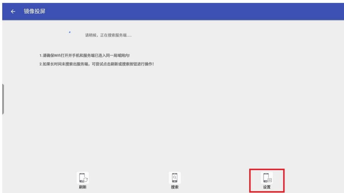
开启自动反镜像, 在默认镜像 IP 处输入主机的有线 IP 地址。设置完成后退出镜像投屏并重新打开, 即自动开始反镜像。此时分机与主机实时联动。
