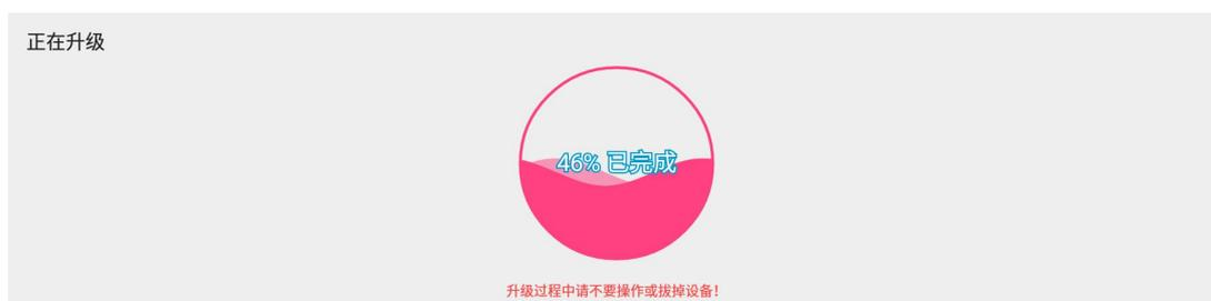
显示升级 100%完成后，自动提示配对界面，此时再进行配对；配对完成后则接上电脑 USB 口进行传屏即可。
