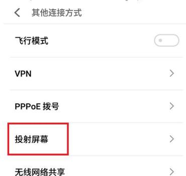
此时投射屏幕手机端会自动开始搜索大屏幕设备。在设备列表中，点击您要连接的大屏幕设备名，即可与大屏幕连接。
