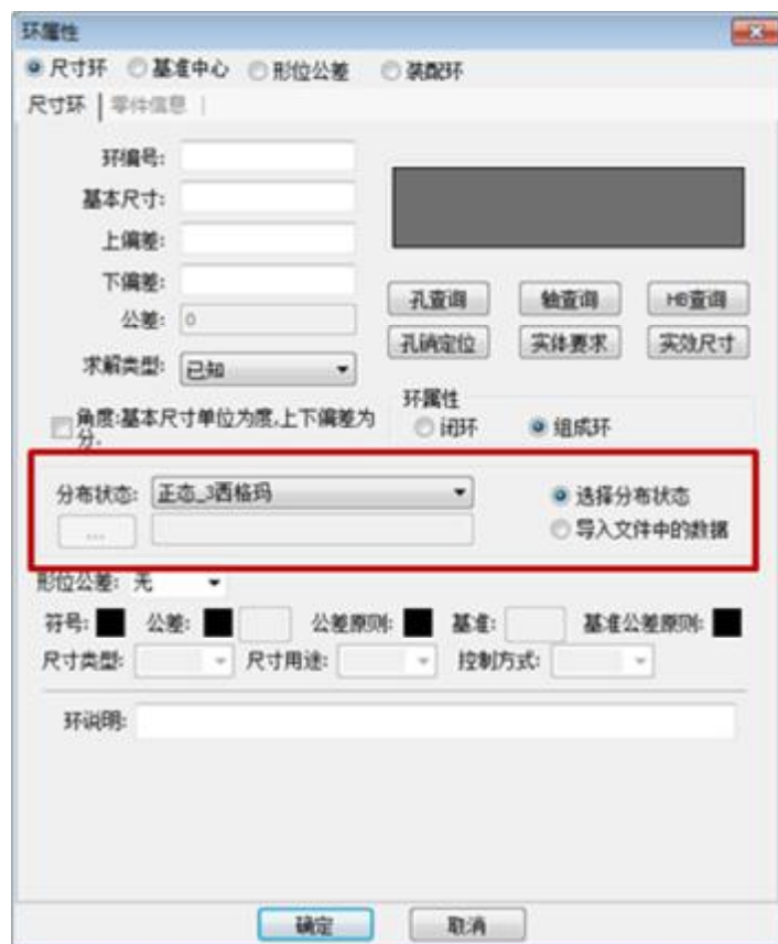
图 3-15 尺寸链计算导入实际加工统计数据
