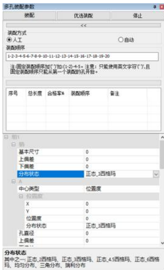
图 3-62 多孔装配参数配置
