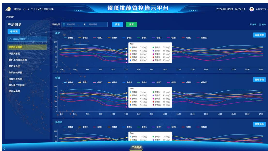
功能描述：系统支持用户对生产设备、监测设备、治理设备产治监关系绑定，对比查看同一时刻设备的数据，对有组织排放污染源全流程监测，有效掌握并科学分析有组织排放分布浓度、变化规律等，并实时进行动态展示，实时掌握有组织排放情况，为企业超低排放治理工作提供有力支撑。
