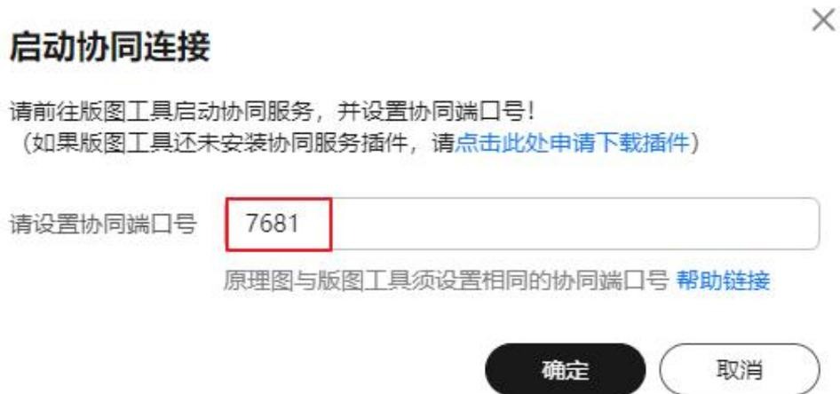
步骤 4 配置完成后，单击“确定”，弹出连接成功提示框，即表示原理图设计和 Allegro 版图设计软件建立协同连接成功，可以开始协同操作。
