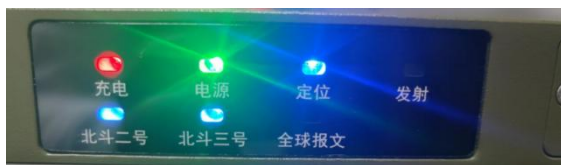
图 5-7 主机状态指示灯
