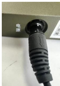
图 5-6 电源线连接示意图
