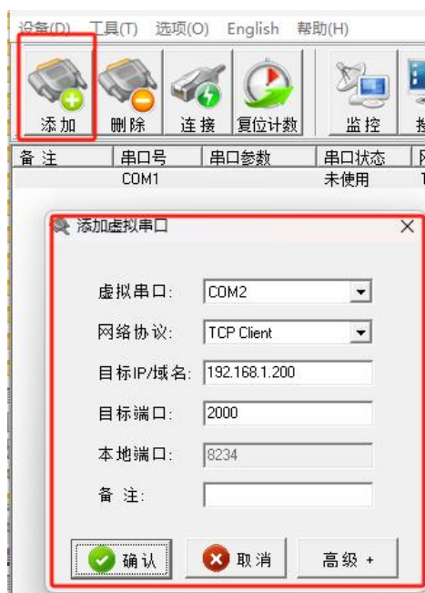
图 5-10 虚拟串口参数设置界面
