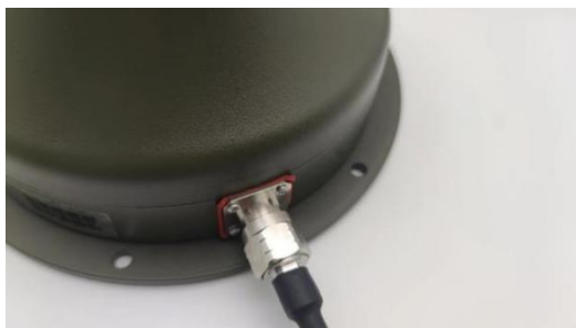
图 5-4 天线端连接示意图
