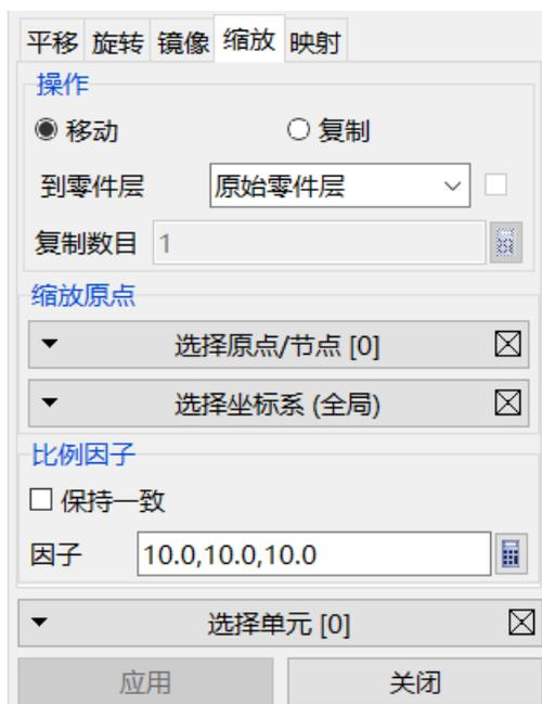
下图定义假人缩放，原始假人 H 点在 (0,0,0) 位置，采用全局坐标系定义缩放方向，原点位置为 (1000,0,0)，在 X,Y,Z 方向使用相同的缩放因子 2。
