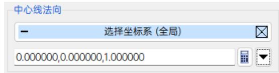
选择一个坐标系，在局部坐标系下定义矢量：圆环体中心点 $\rightarrow$ (DX, DY, DZ)，矢量方向为圆环体的中心线法向。
