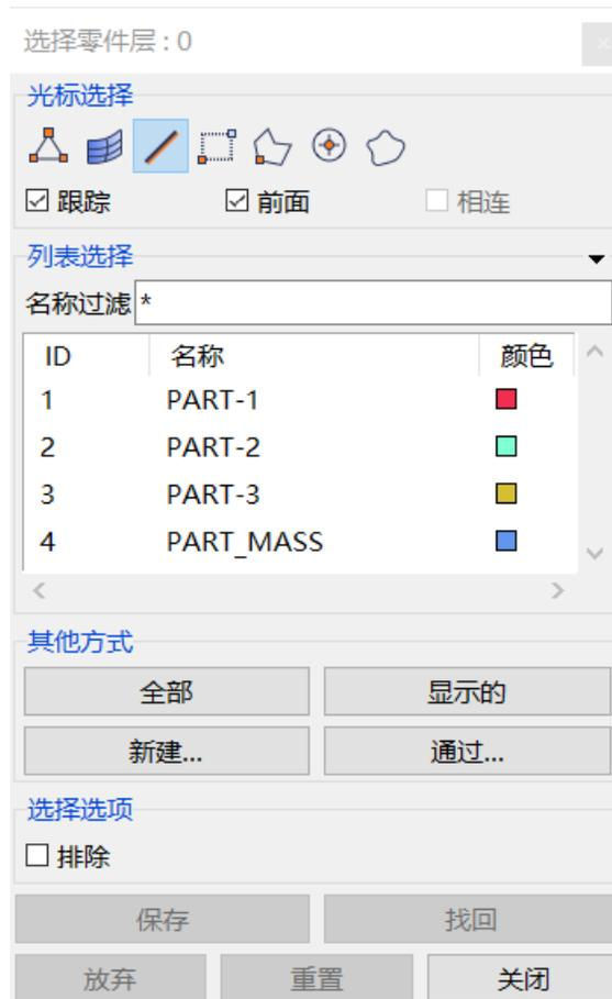
✧ **通过零件层组**：通过零件层组选择零件层，继而选中零件层中所含对象。选择该选项后，弹出下图所示选择零件层组窗口，用户选择零件层组，随后点击**关闭**按钮，则所选零件层组中包含的所有对象均被选中。
