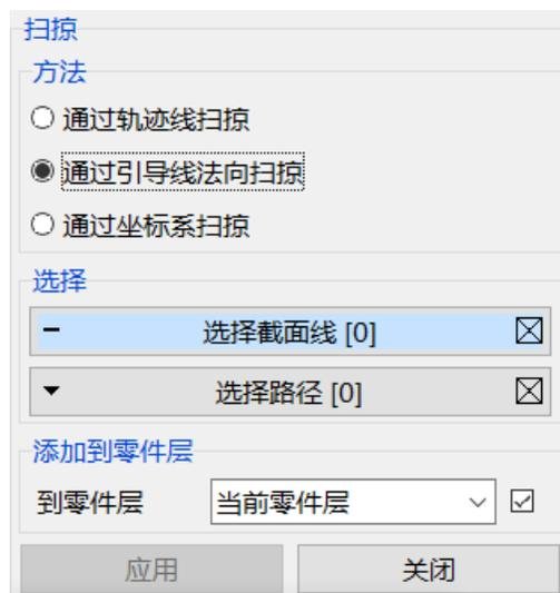
如上图，选择**通过引导线法向扫掠**，此方法沿着引导线进行扫掠时，会调整截面线方向，保证截面线与引导线垂直状态。操作过程与沿轨迹线扫掠相同。
