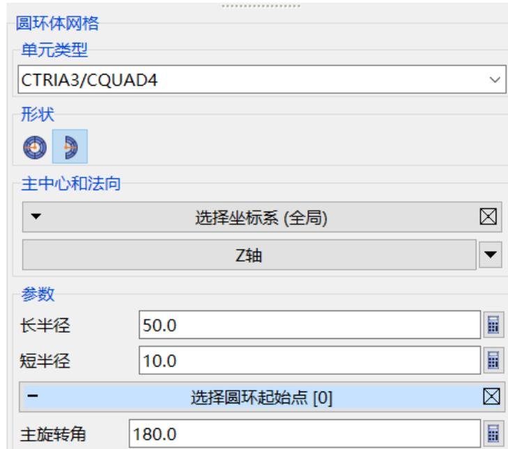
**圆环起始点：**选择一个节点/点 P3，该点与 P1，P2 所形成的平面确定了圆环起始点所在平面，圆环起始点的具体位置有圆环法向和长半径决定。
