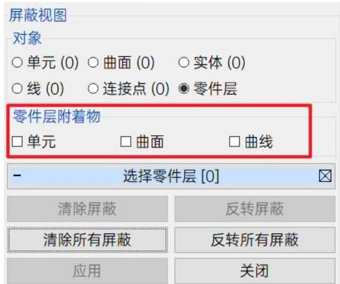
2) 若操作对象为**零件层**, 则用户可选择零件层中需要清除屏蔽或反转屏蔽的对象类型, 勾选相应的零件层附着物。如下视图中, 显示了对零件层15中的单元, 进行反转屏蔽, 和消除屏蔽的效果。
