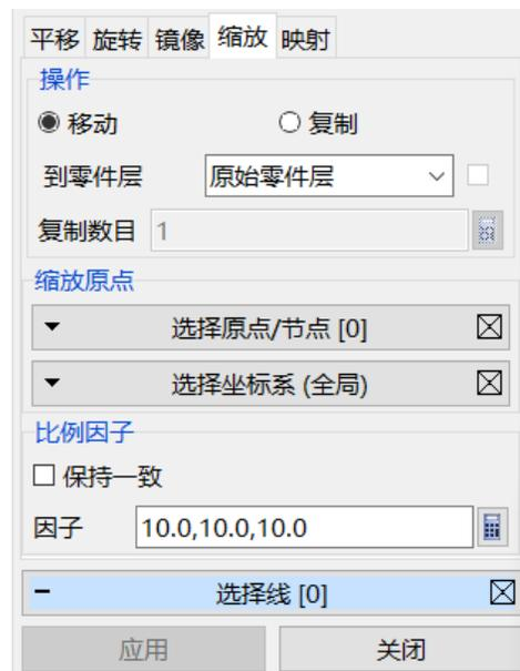
选择一个坐标位置，定义缩放的原点；选择坐标系定义缩放的方向，将曲线缩放一定的比例。
