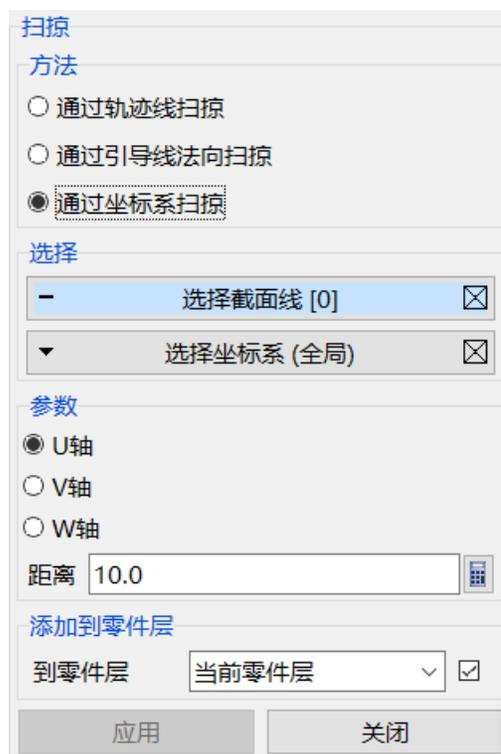
如上图，选择**通过坐标系扫掠**，则在选择路径时，用户可选择全局或局部坐标系的坐标轴作为引导线进行扫掠。操作过程如下：
