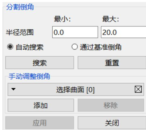
在网格划分时，在倒角的中间分布一层节点，可使得网格划分的精度更高。此功能可自动搜索显示的几何模型中，存在的倒角，并分割该倒角，在倒角的中间生成共享边，如下图所示。
