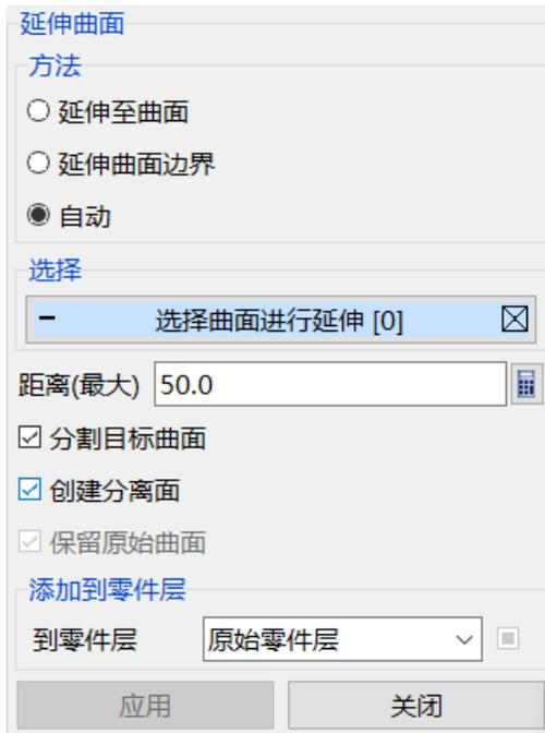
**最大间隙：**PERA SIM Mechanical 以此参数范围为界限决定是否延伸曲面，仅在间隙距离小于等于 1.2 倍此值时进行延伸。如下图所示，延伸长度分别为 5、6、7，设定最大延伸距离为 5，自动延伸曲面后结果如右图所示：
