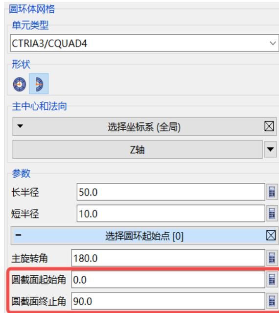
**圆截面旋转方向：**对矢量 P1, P2 和矢量 P1, P3 应用右手法则，旋转方向即为圆截面旋转方向。
