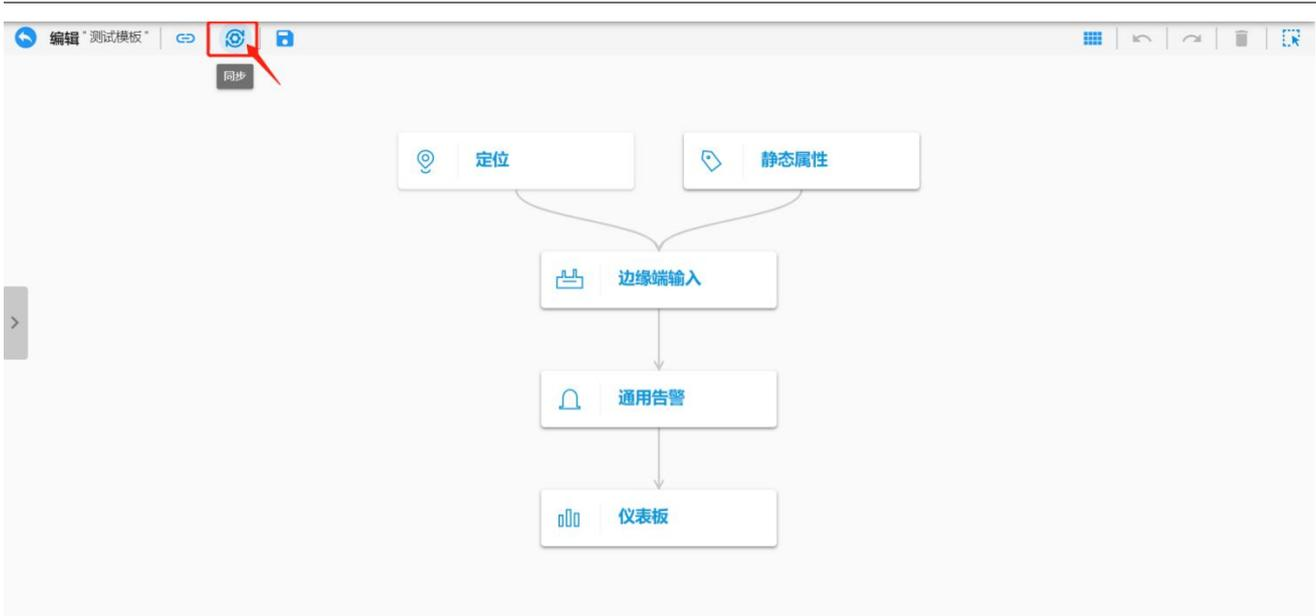
点击同步按钮后，将会弹出如下界面（如果当前模板没有被任何资产组中的节点所使用，则界面右侧节点信息将显示为空），我们可以在页面左侧勾选需要同步的组件，同时在页面右侧勾选需要同步的节点，完成对指定节点配置同步和更新：
