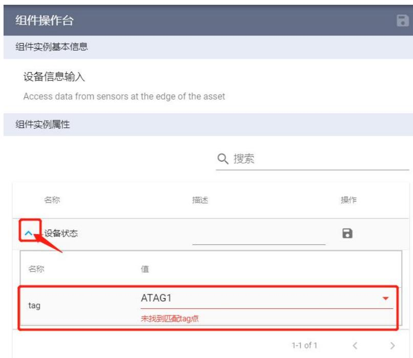
26. 点击实例属性值右侧的“下三角”，进行手动选定配置：
