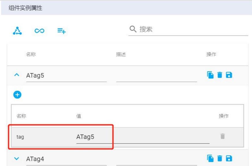
5. 可以点击属性名称右侧的按钮，对属性进行复制、删除和保存操作，编辑完成后点击右上角的“保存”按钮即可完成组件数据的绑定：
