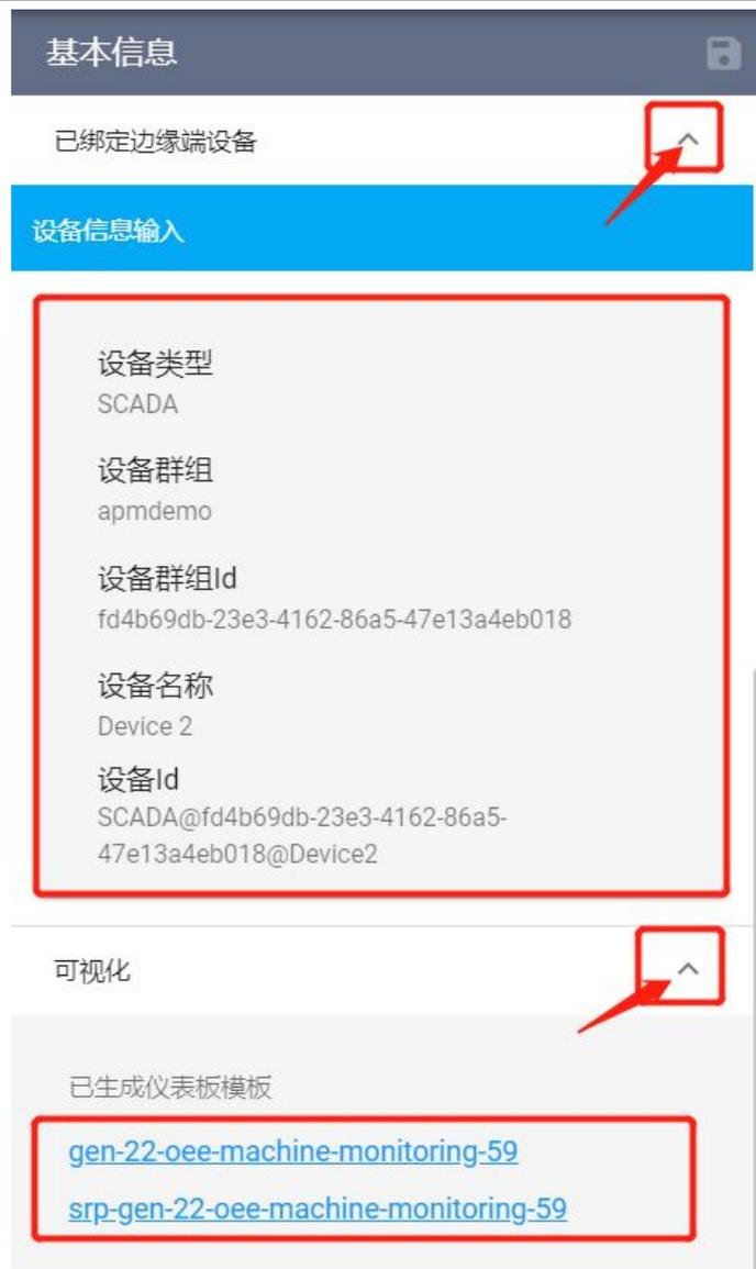
22. 双击产线节点查看产线信息，产线并没有绑定实际的边缘端设备，但我们已经为节点配置了可视化仪表板，所以在“可视化”栏位可以看到自动为产线节点所生成的可视化链接地址（通过此地址可以进行所选定节点的数据可视化展现）：
