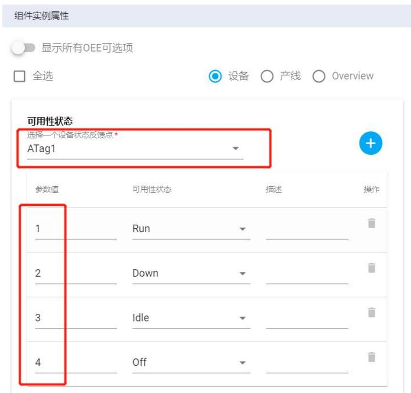
5. 对于一种状态可能对应多个值的情况，可以点击右侧的“+”按钮添加映射关系，新添加的映射关系可以通过点击右侧“垃圾桶”按钮进行删除：
