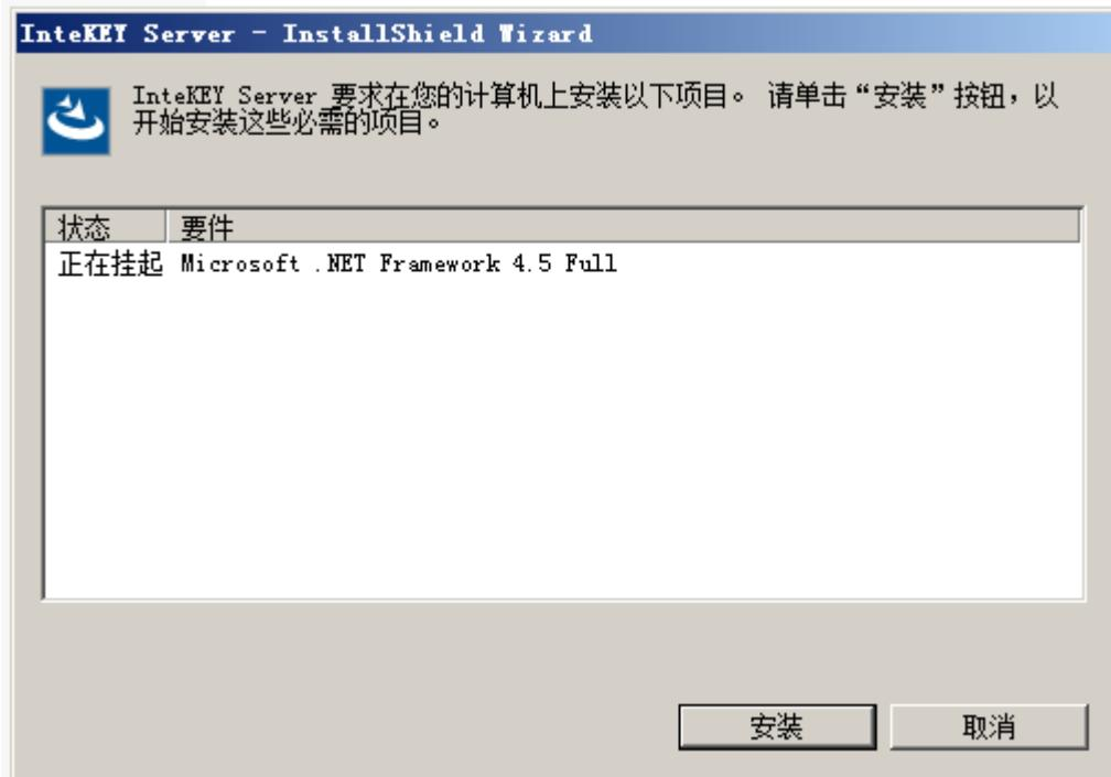
注：该界面是检测当前系统需要安装的系统补丁，根据系统配置，显示挂起的补丁会有所不同。建议在安装.net4.5 等补丁时需要耐心等待。如果系统已经安装对应的补丁，则不会显示该界面，直接进入 InteKEY Server 安装界面，即步骤 3。
