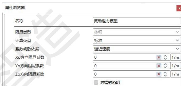
图 5-22 流动阻力模型参数设置
