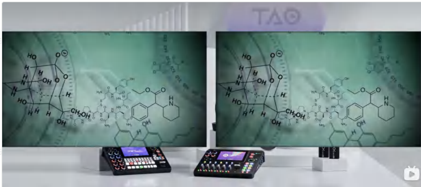
HDMI OUT（右）和HDMI LOOP（左）都显示HDMI IN口接入画面
