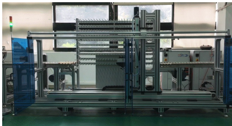
实物设备（堆垛机）
