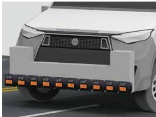
测量路面平整度
