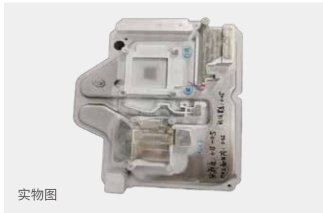
水冷板组件轮廓度、位置度检测 参考型号: LVM2040
