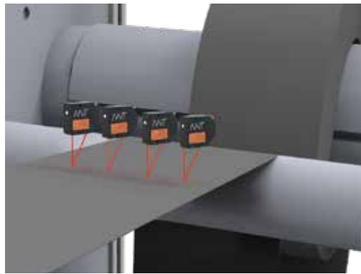
测量轧制钢板的垂度
