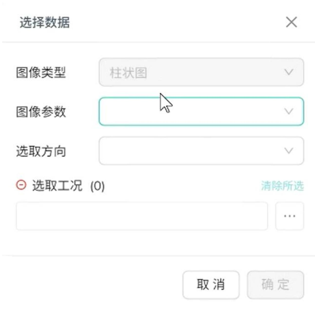
5. 根据界面提示选择需要预览的图像参数、选取方向、选取工况，单击确定，显示直方图。
