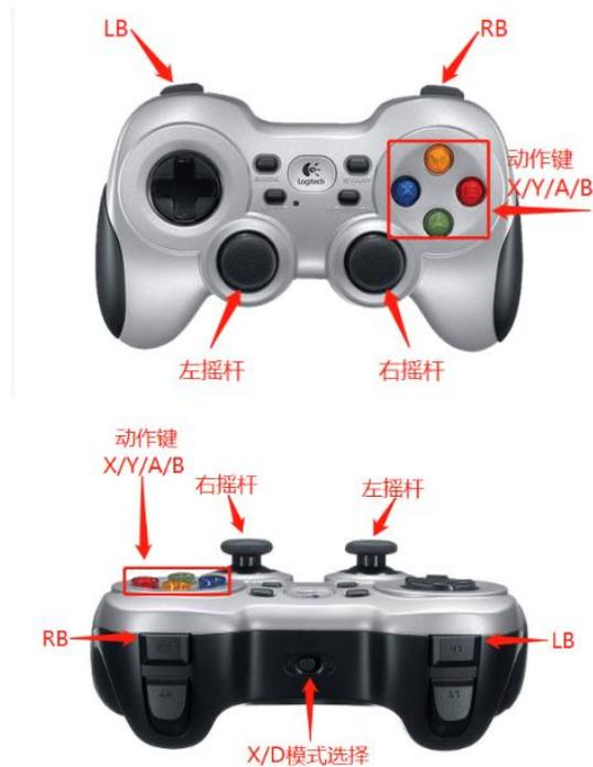
将 X/D 模式选择键位滑动至 X 档，按键任意动作键，遥控器左指示灯频闪十秒内熄灭则为连接成功，单击 LB 动作键即可进入遥控模式，左摇杆控制前进后退，右摇杆控制左转右转，使用完毕后单击 RB 键即可退出遥控模式。Y 键为直线行驶加速键，A 键为直线行驶减速键，X 键为转向加速键，B 键为转向减速键。
