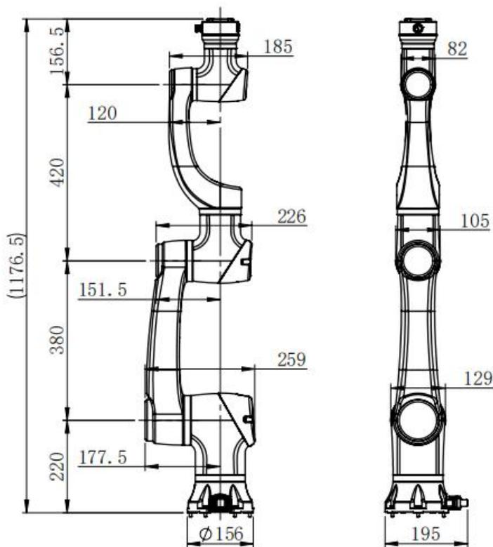
常规臂最大负载5kg机型尺寸图
