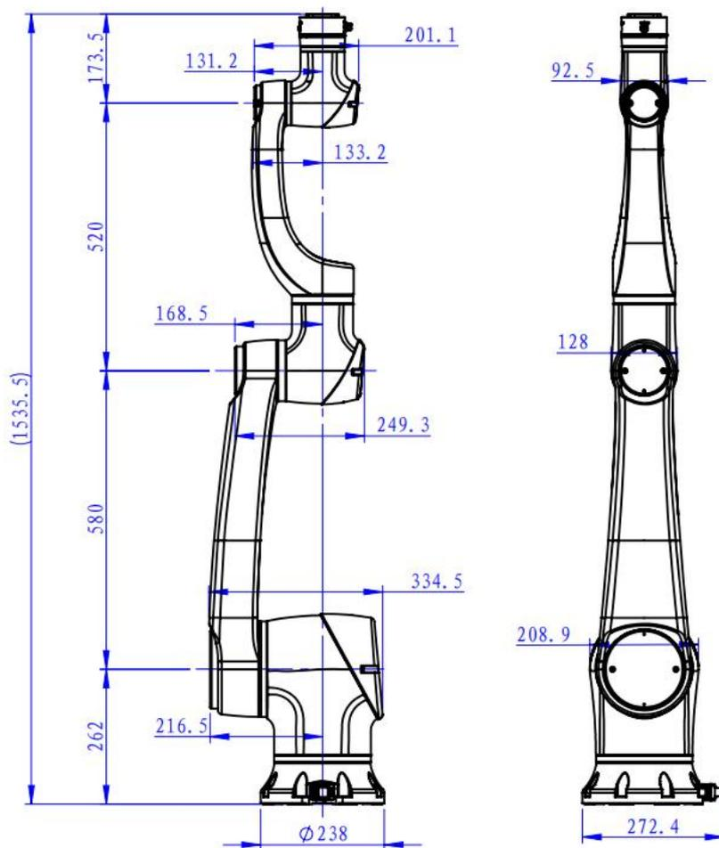
常规臂最大负载18kg机型尺寸图
