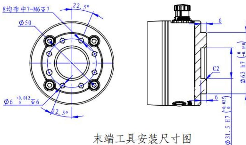
末端工具安装尺寸图
