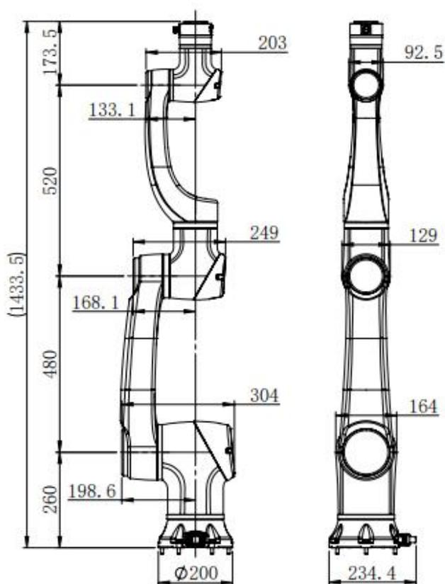
常规臂最大负载10kg机型尺寸图
