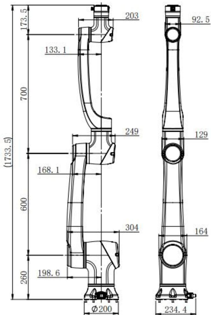
加长臂最大负载8kg机型尺寸图
