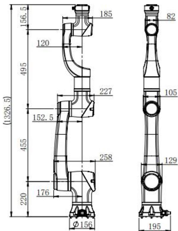
加长臂最大负载3.5kg机型尺寸图
