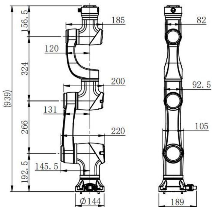
常规臂最大负载3kg机型尺寸图
