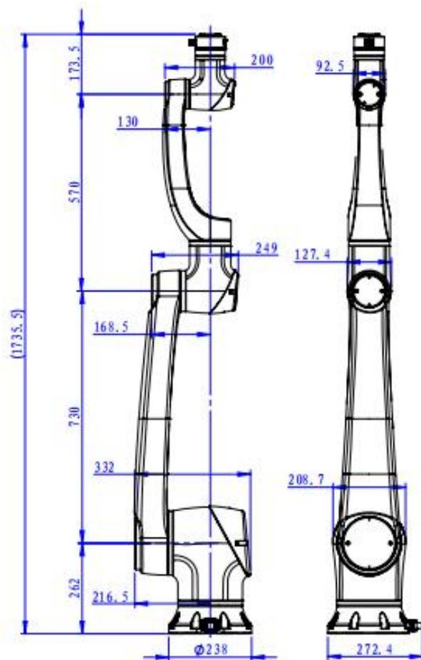
常规臂最大负载15kg机型尺寸图
