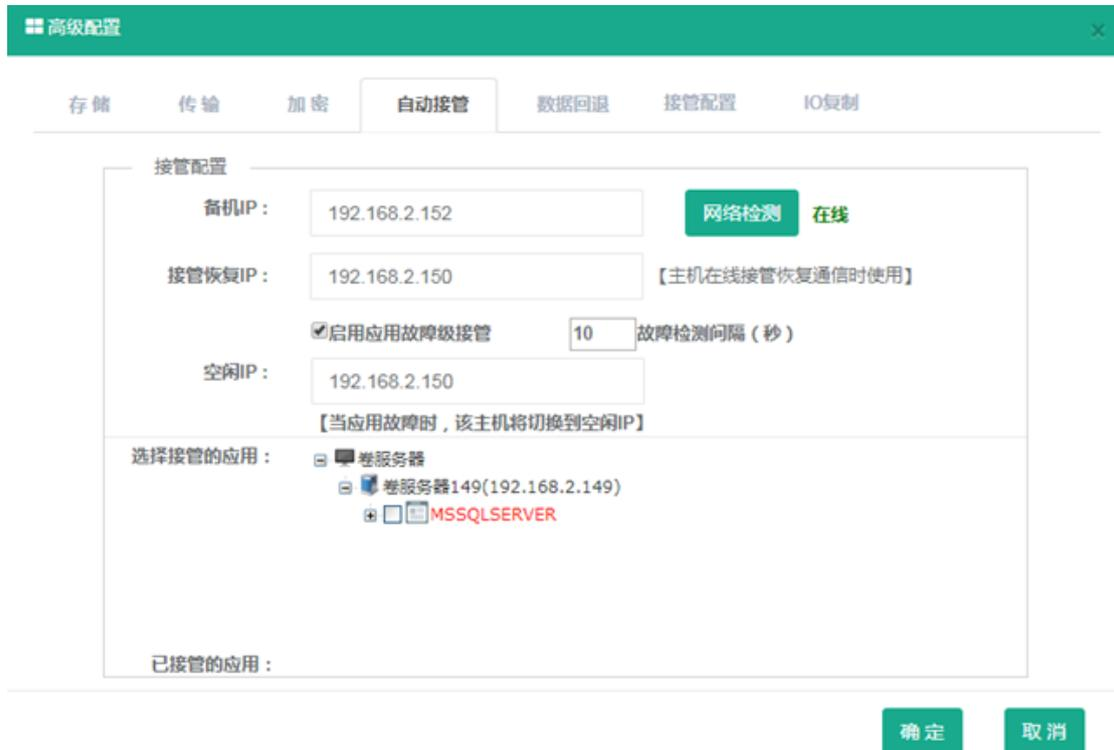
图 5-358 自动接管配置
