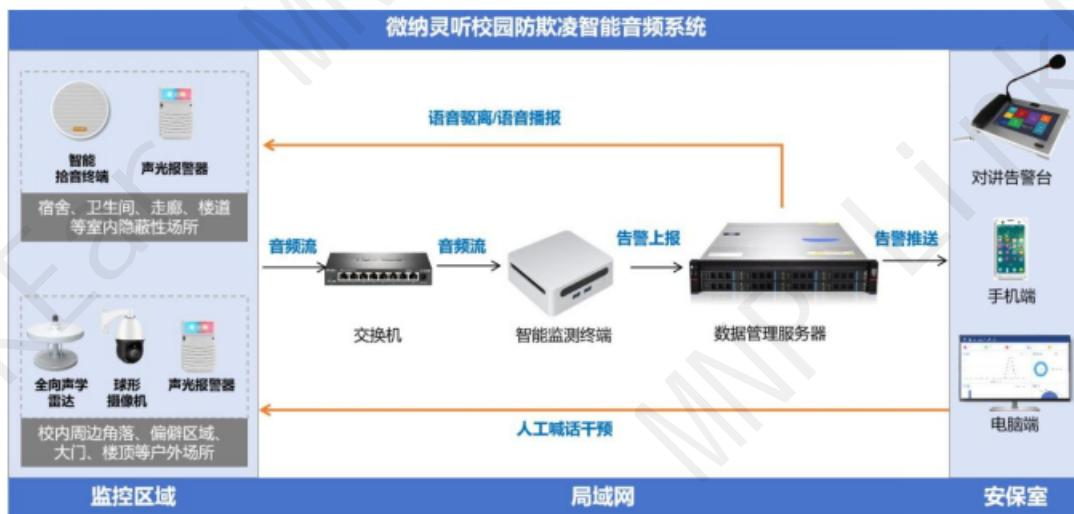
系统在 AI 降噪高清拾音的基础上，集成了 AI 听觉智能监测分析系统和对讲广播系统，融合语音识别、语音唤醒、语音通信技术应用于校园防欺凌、校园安全管理中，对校园内的欺凌或异常事件实时监听和预警，完善校园安全管理手段，实现校园的安全智慧运营。
