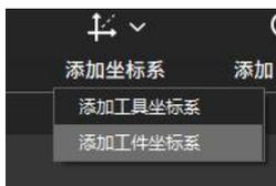
资源树-任务，用户坐标系下新增一个 User 坐标系。新增的 User 坐标系默认和世界原点重合，点击 User 坐标系节点，打开相应 User 坐标系属性面板，可以修改参数
