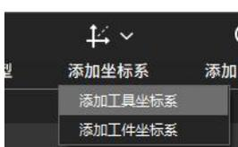
资源树-任务，工具坐标系下新增一个 Tool 坐标系。新增的 Tool 坐标系默认和机器人法兰末端 Tool0 重合，点击 Tool 坐标系节点，打开相应 Tool 坐标系属性面板，可以修改参数
