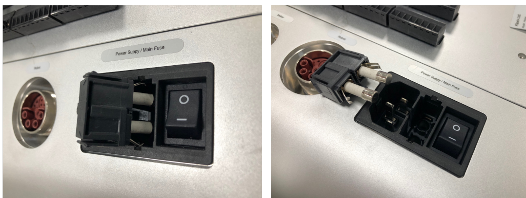
图 8.1: 交流电筒式熔断器拉出以供维护时的示例图片
