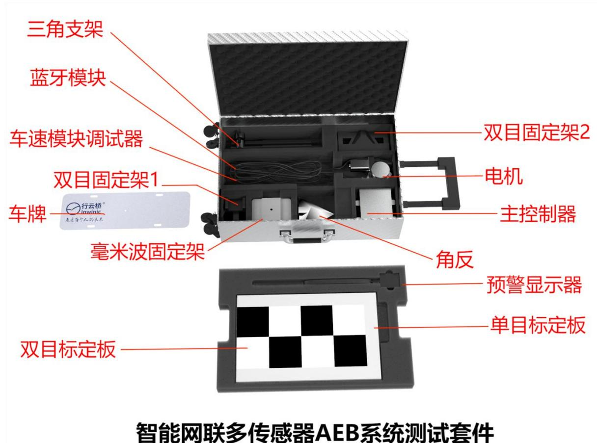
智能网联多传感器 AEB 系统测试套装里有各种辅助使用智能网联多传感器测试实训箱的配件，辅助标定的有角反、双目标定板、单目标定板，辅助固定的有双目固定架 1、双目固定架 2、毫米波固定架、车牌、三角支架，用于实现 AEB 的部件有电机、主控制器、预警显示器、蓝牙模块、车速模块调试器
