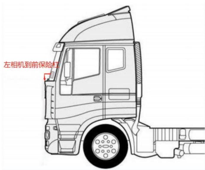
d) 车辆左侧相机距前挡风玻璃右边缘的距离 (单位: cm) ;
