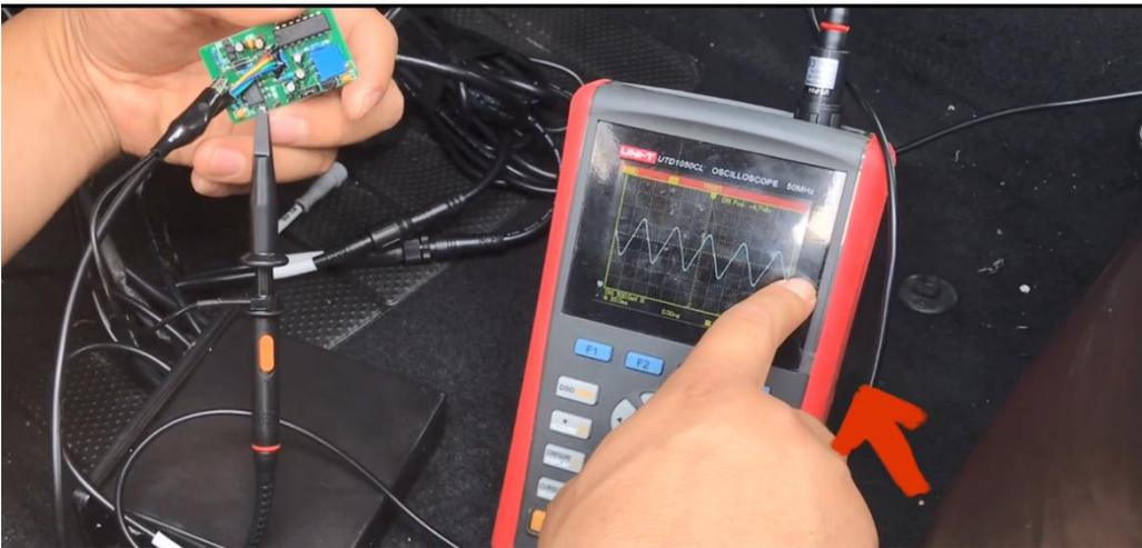
接着将钩形测试夹接入基准针，调节车速模块内滑阻，保持示波器上的参数不变，调节基准线至屏幕中央，目的保证基准线与标准波中心线重合
