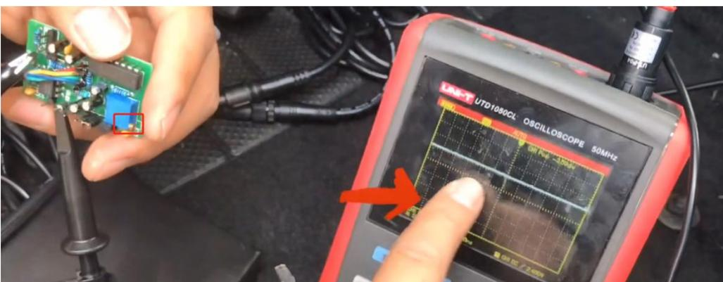
最后将钩形测试夹接到车速模块的输出针上，确认波形上电压为 12v 左右，则认为正常，到此轮速获取确认完毕。
