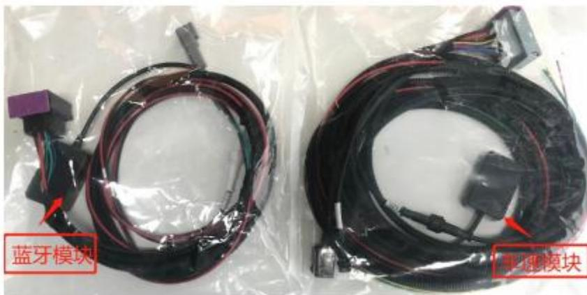
主控制连接线+双目 CAN 线+左、右转向、刹车信号线+轮速线+车速模块调试器+蓝牙模块
