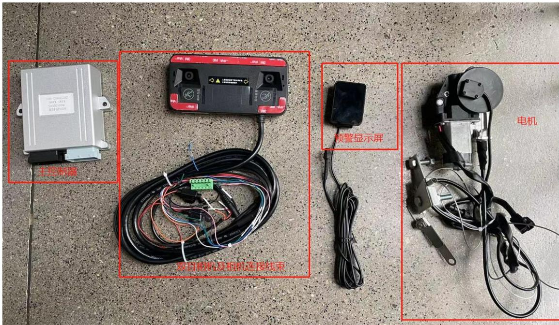
线材：双目电源线、双目相机 CAN 线、主控制器连接线、执行机构（电机）连接线、信号线（左转、右转、倒车、刹车、轮速线）；
