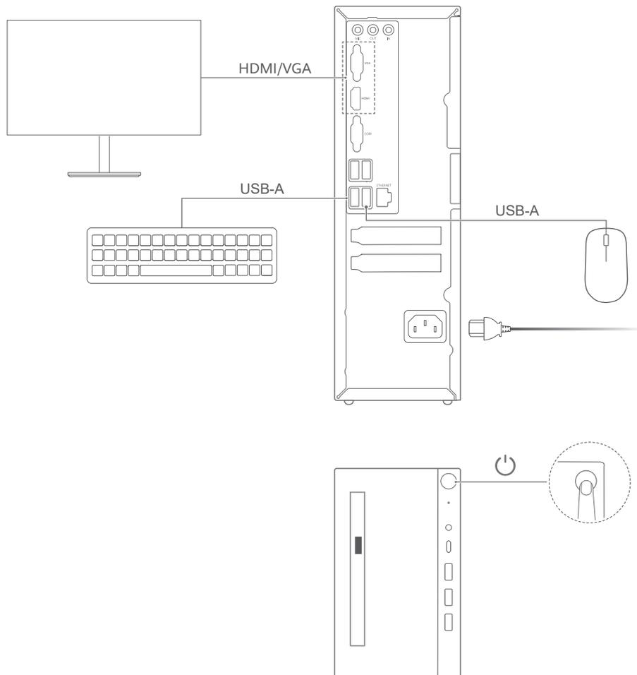
1. 完成显示器、鼠标、键盘、电源等连线后，短按电源键启动计算机。
