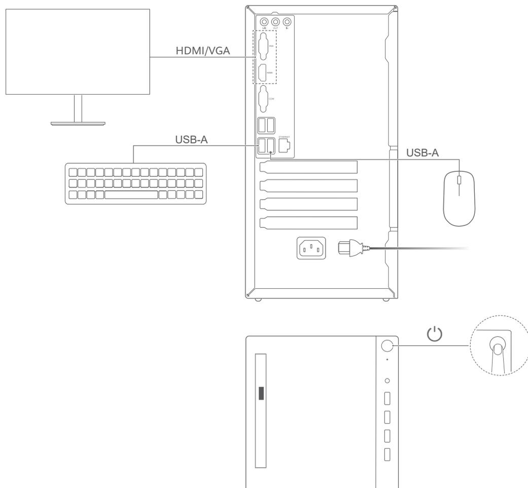
1. 完成显示器、鼠标、键盘、电源等连线后，短按电源键启动计算机。
