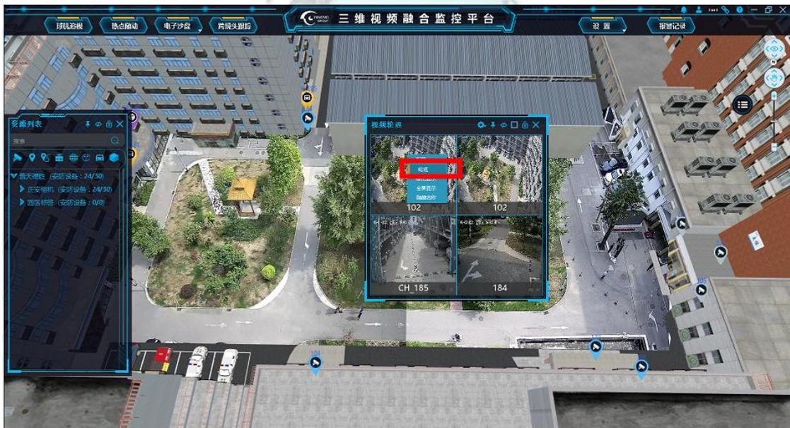
➤ 右键视频窗口，弹出子菜单中，点击等比显示，进行等比显示，调节展示视频的窗口，点击全屏显示，该视频窗口最大显示铺满轮巡视频窗口（非显示器窗口），点击“隐藏名称”则将视频窗口下方的摄像机名称隐藏；
