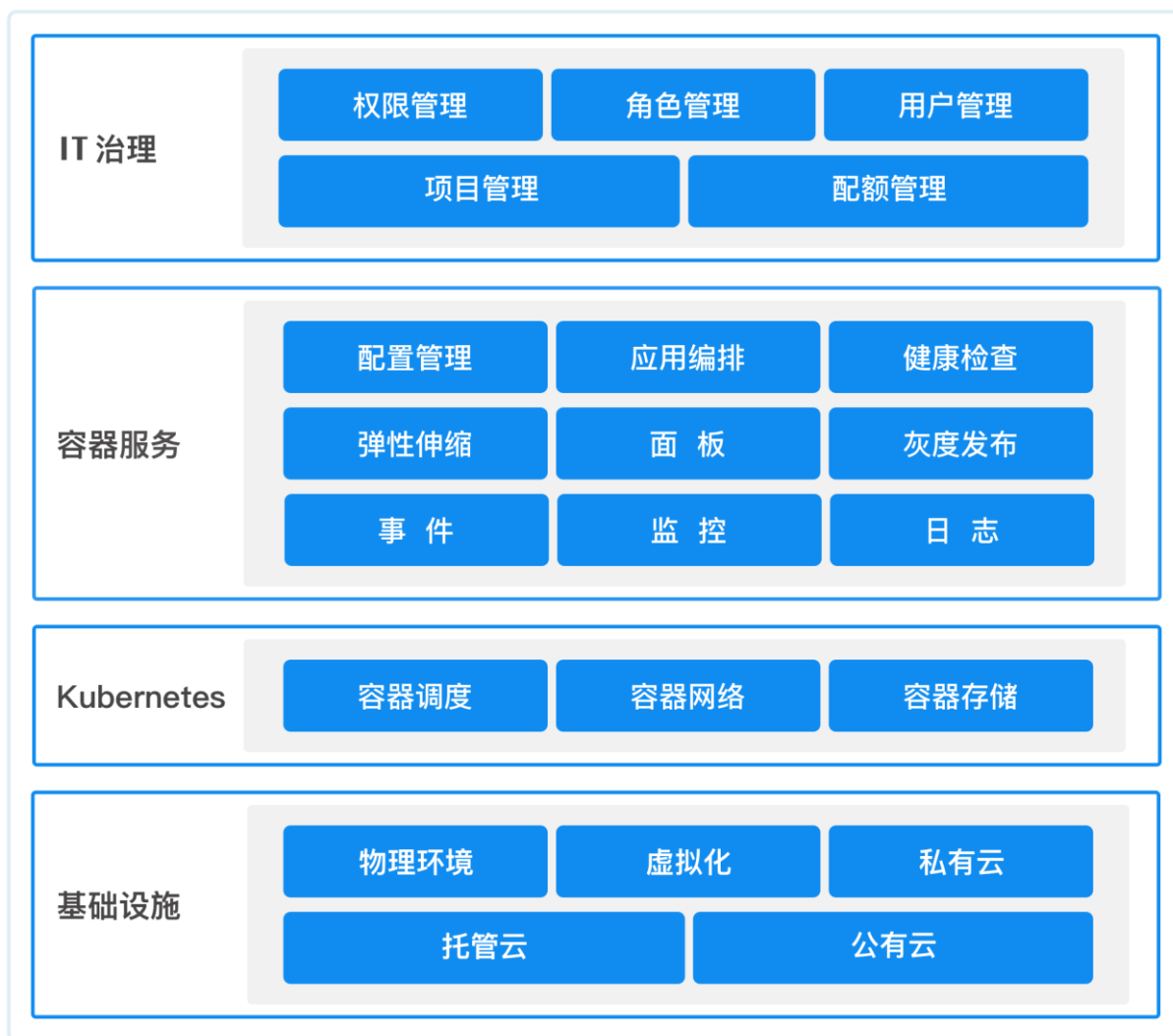
图 2-1 Container Platform 产品结构图
